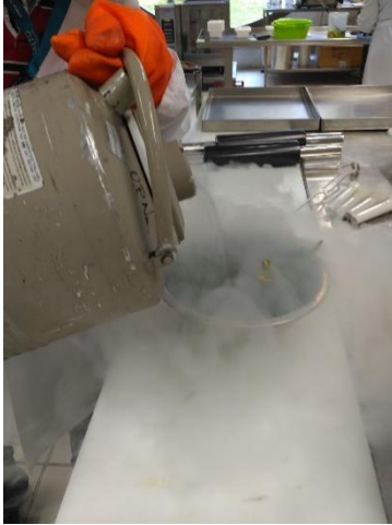
Figura 10.- Ultracongelación de hinojo marino mediante nitrógeno líquido
