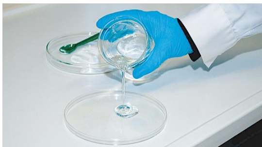
Figura 4.- Solución formadora de películas siendo vertida en una placa de vidrio (Parzanese, 2006)
