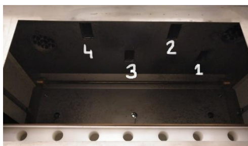
Figura 4. Cabina del microondas indicando las posiciones de los generadores (del 1 al 4)
