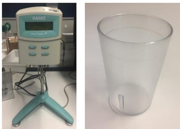
Figura 7. Viscosímetro ViscoTester 7R (Haake, Karlsruhe, Alemania) y vaso utilizado.
