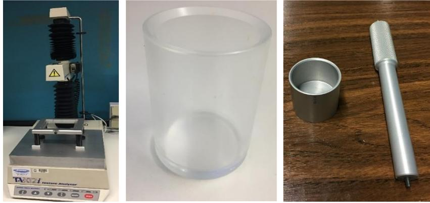
**Figura 6.** *Texturómetro TA-XT2i Texture analyser, vaso, sonda de aluminio P/35 y vástago utilizados en el presente trabajo.*
