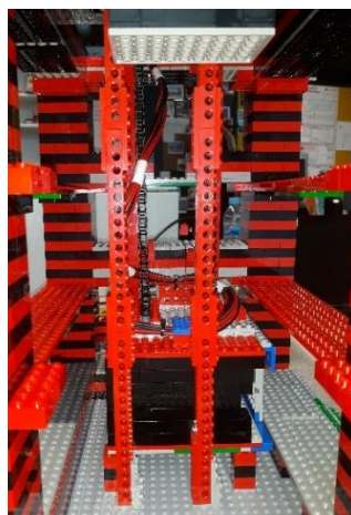
Figura 12 Guías verticales para la cabina
