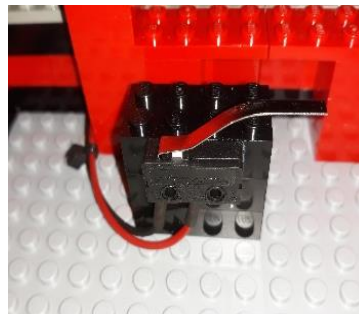
Figura 6 Apoyo final de carrera inferior
