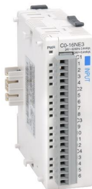
Figura 32 Módulo adicional de entradas PLC (Fuente [7])
