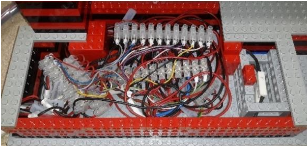
Figura 23 Caja de registro
