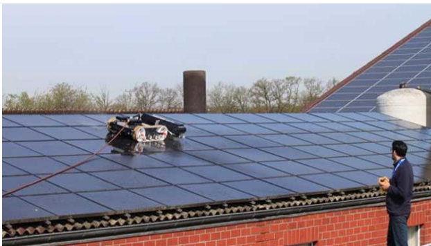
Fig.3.5. Sistema teledirigido de limpieza(hyCleaner).
