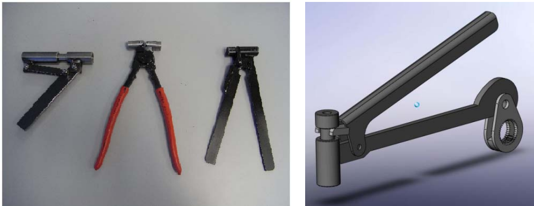
Figura 4.18: Herramientas para el cambio de electrodos. Modelos iniciales y modelo definitivo
