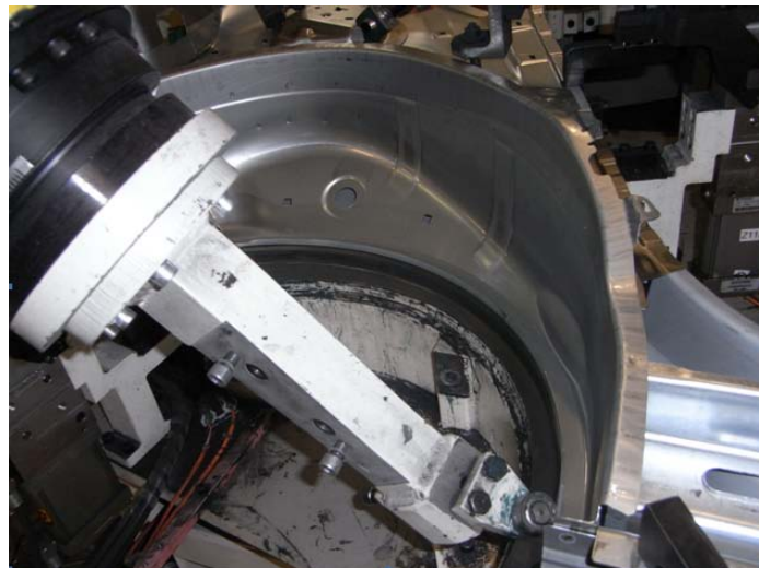
Figura 4.14: Engrapado del Pasorruedas
