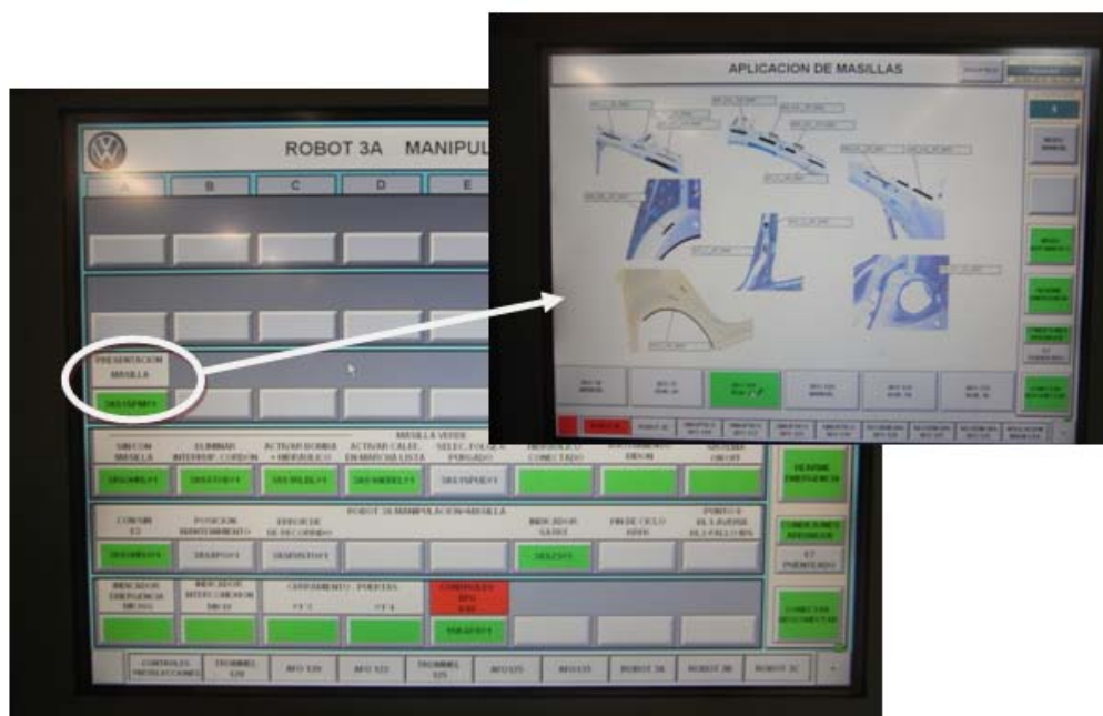
Figura 4.20: Verificación de la aplicación de masilla
