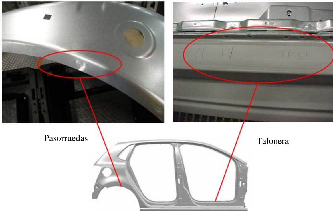
Figura 4.13: Zonas de aparición de bollos en los laterales
