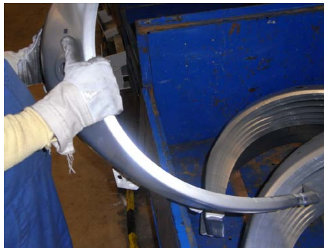
Figura 4.17: Manipulación correcta del pasorruedas
