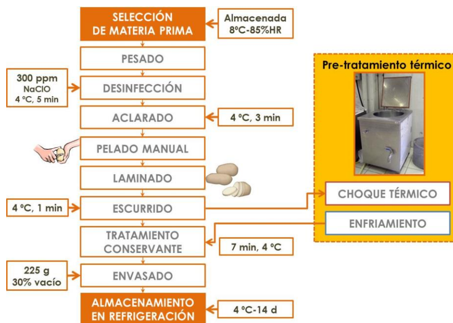
Figura 1.2. Diagrama de procesado con un choque térmico previo al tratamiento con la solución antipardeante (Bloque B).
