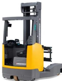
*Ilustración 12: Retráctil multidireccional. Fuente: JUNGHEINRICH[8]*
