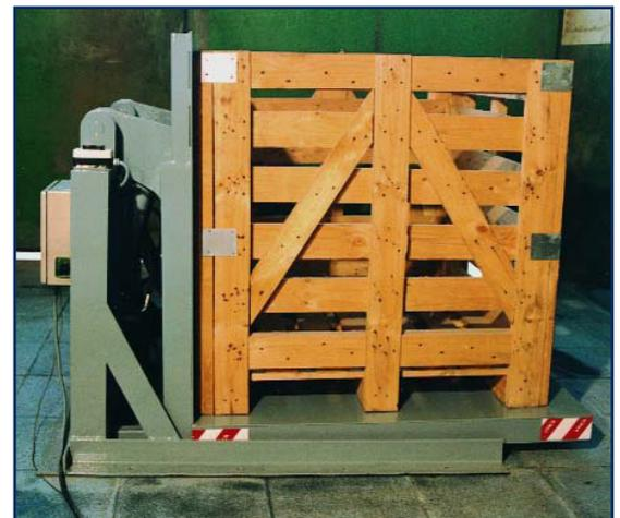
Volteador en funcionamiento para "palots" (cestones de madera normalizados).
