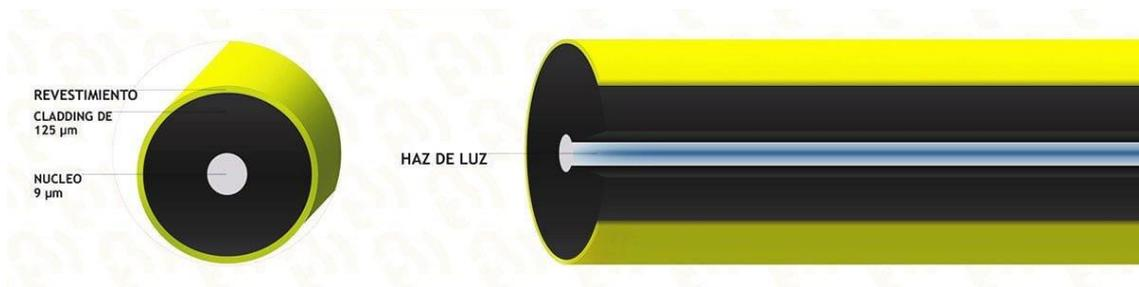
Figura 3. Estructura típica de una fibra óptica monomodo [14].
