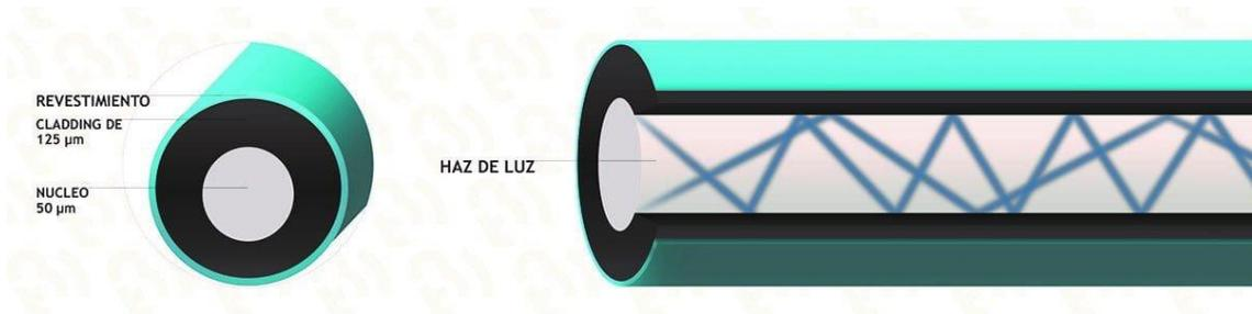
Figura 4. Estructura típica de una fibra óptica multimodo [16].
