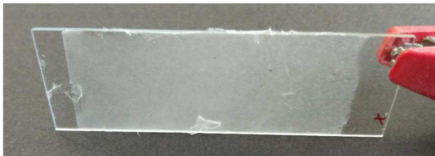
**Figura 22.** *Fibras sobre porta de vidrio sin tratar. Se puede apreciar como las fibras están sueltas.*
