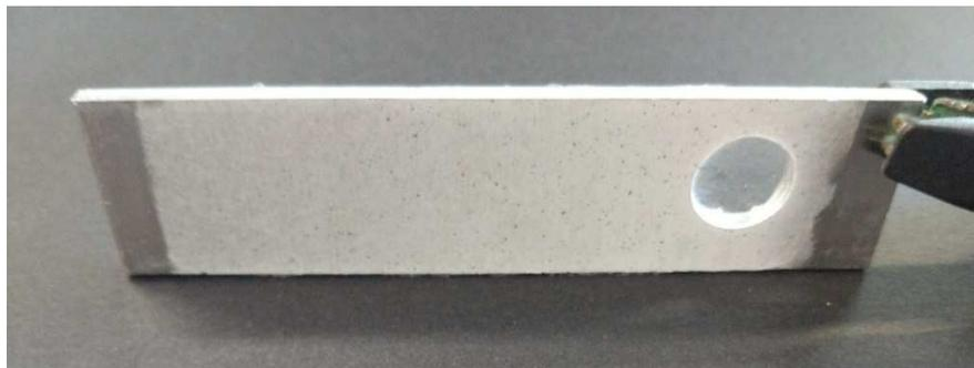
**Figura 21.** Recubrimiento de PAA +  $\beta$ -CD +  $\text{TiO}_2$  sobre sustrato de aluminio 6061.
