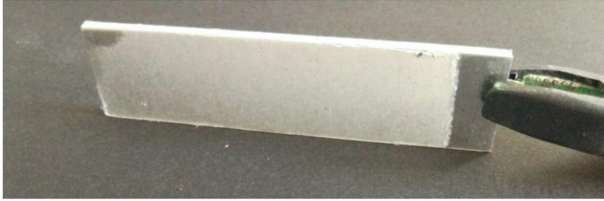
**Figura 19.** Recubrimiento de PAA sobre sustrato de aluminio 6061.
