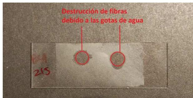
**Figura 24.** Destrucción de fibras de PAA sin tratar al aplicar gotas de agua.
