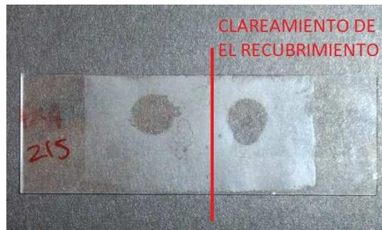
**Figura 25.** Daño en recubrimiento de PAA tras la inmersión. Izquierda: No inmersión. Derecha: Inmersión.
