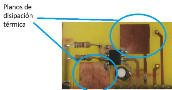
Figura 117: Montaje de los drivers en la PCB de potencia
