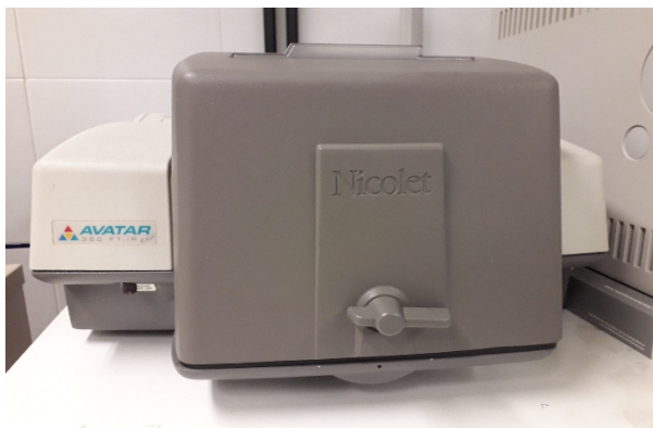
Fig. 2.4. Espectrómetro Nicolet Avatar 360 FT-IR.
