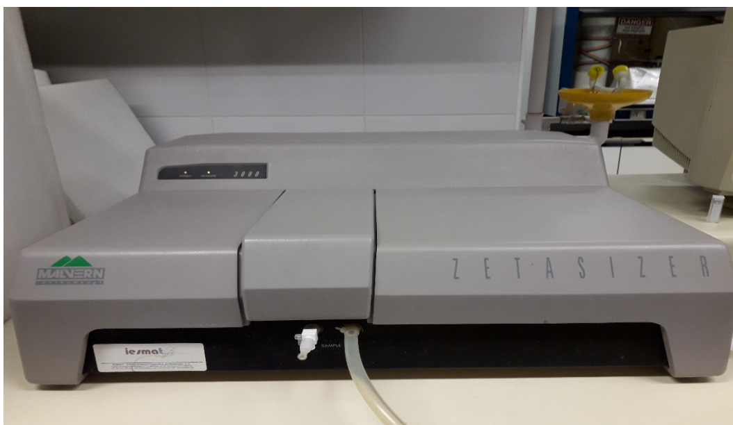
Fig. 2.8. Espectrofotómetro de correlación fotónica Zetasizer 3000.
