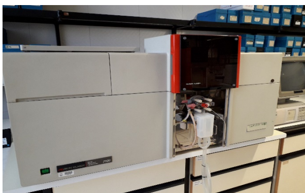
Fig. 2.3. Equipo de espectroscopia de absorción atómica Perkin Elmer 2100.
