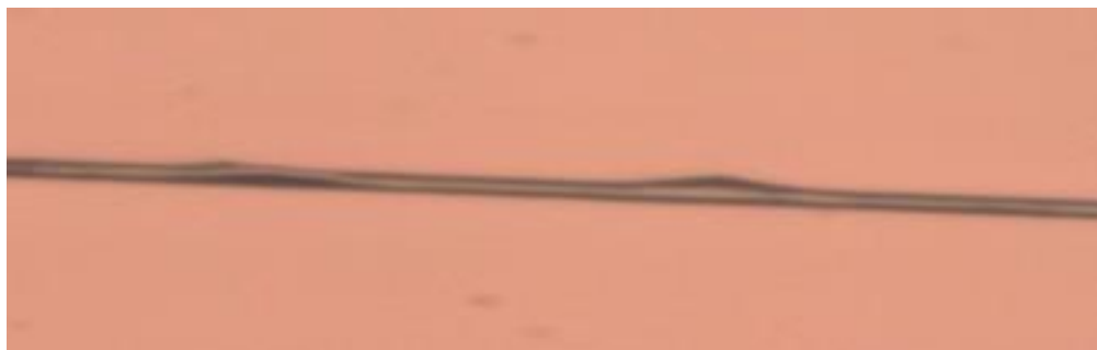
Figura 20. Defectos ocasionados por una mala aplicación del ácido
