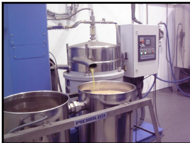
Ilustración 15. Centrifuga vertical Pieralisi
