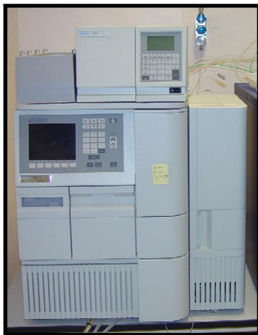
Figura 32. Cromatógrafo de líquidos Waters Alliance HPLC con detector de índice de refracción (RI) 2414, de Waters, con el que se realiza la cromatografía líquida de alta resolución para la determinación del ECN42 real.
