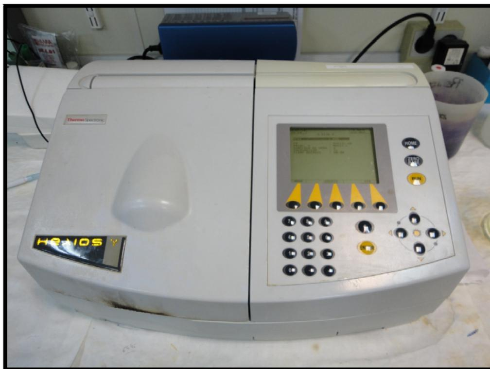
Figura 28. Espectrofotómetro Thermo Spectronic Helios Gamma
