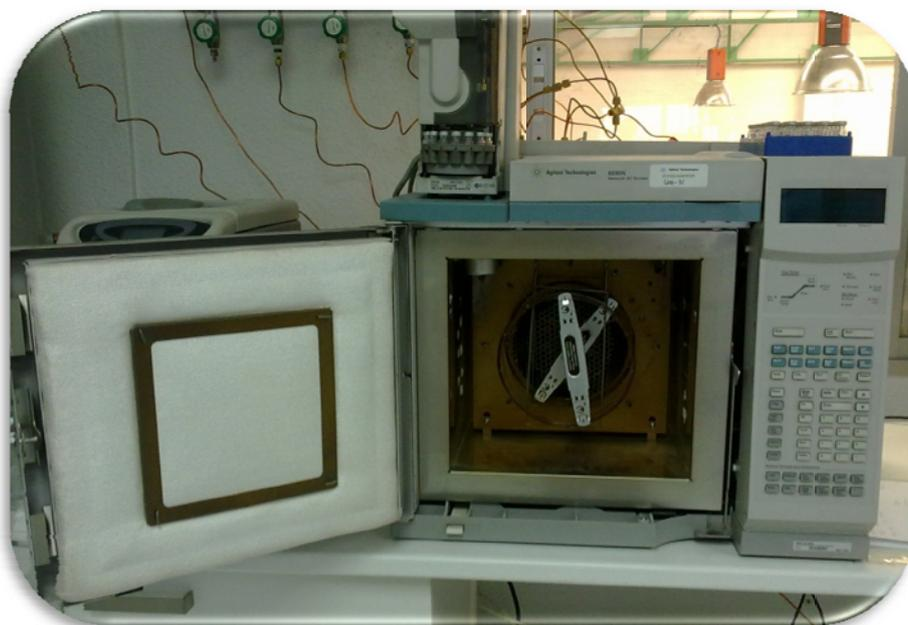
Figura 34. Cromatógrafo de gases con el horno abierto utilizado para la determinación del estigmastadieno, la composición de los esteroides y la cuantificación de los esteroides totales y el eritrodol + uvaol.
