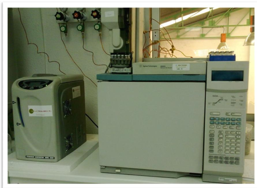
Figura 30. Cromatógrafo de gases Agilent 6890N para la determinación de los estigmastadienos y los esteroides con sistema de inyección automática de muestras Agilent 7683 ALS
