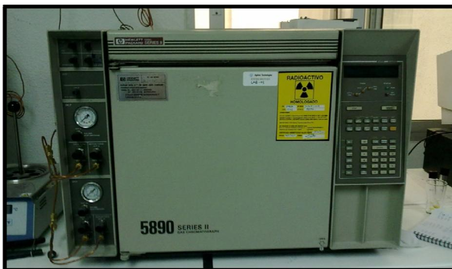
Figura 31. Cromatógrafo de gases HP 5890 para la determinación de la composición de ácidos grasos
