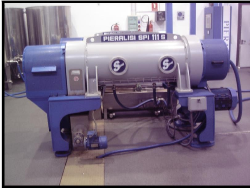
Ilustración 14. Decánter Pieralisi SPI 111 S
