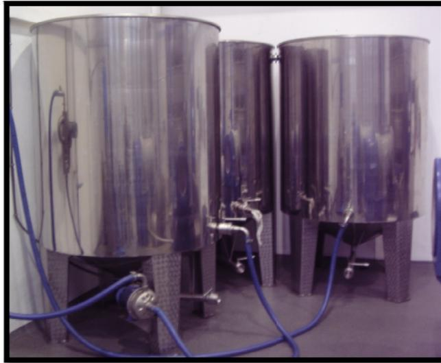
Ilustración 16. Depósitos de decantación
