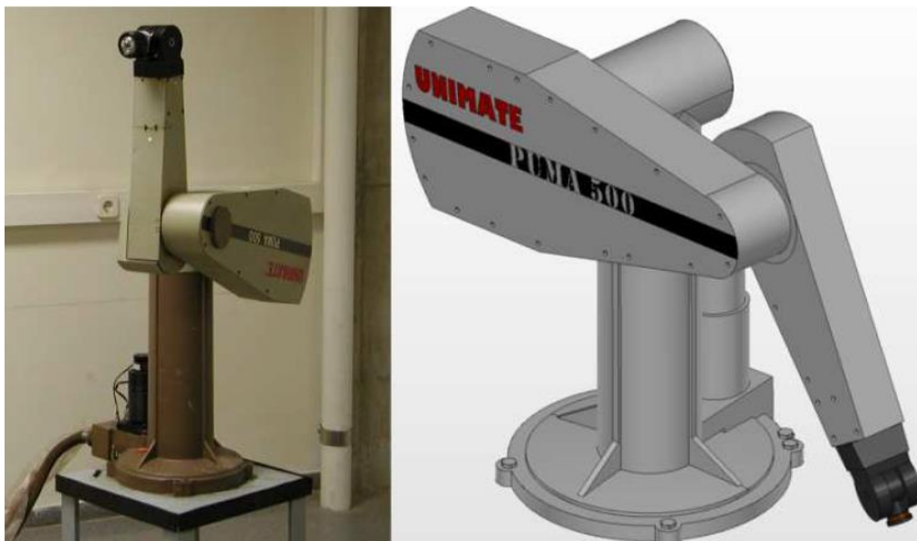
Figura 1 Ejemplo de alta movilidad: Izq.) Sistema Actual, Der.) Modelo CAD
