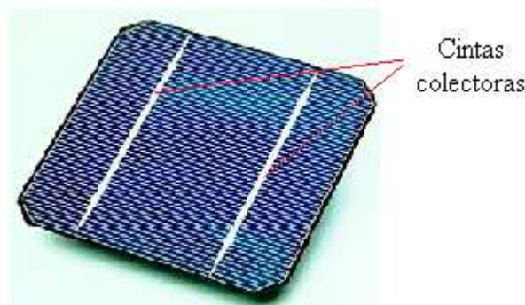
Figura 2. Cintas colectoras de una célula solar
