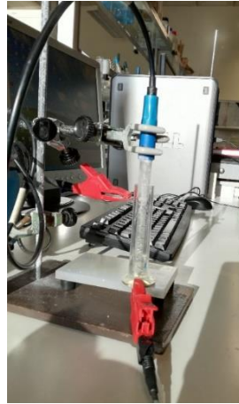
Figura 18. Celda electroquímica para el ensayo de picaduras.
