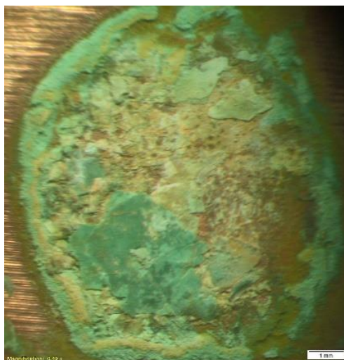
Figura 35. Fotografía de la muestra B3 tras ensayo de picadura recogidas por microscopio óptico.
