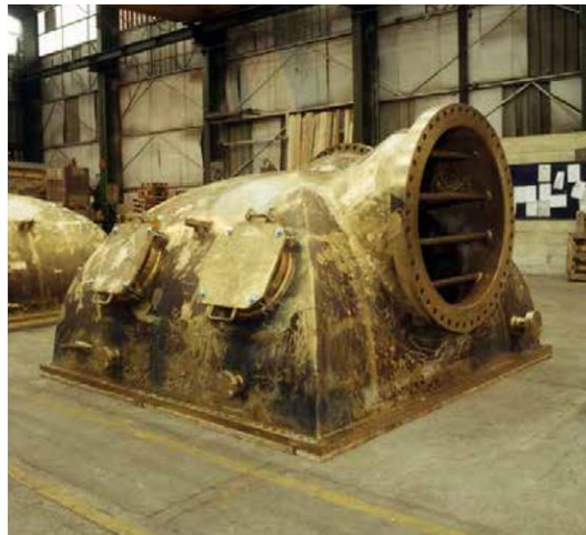
Figura 6. Cubierta superior del condensador [6].
