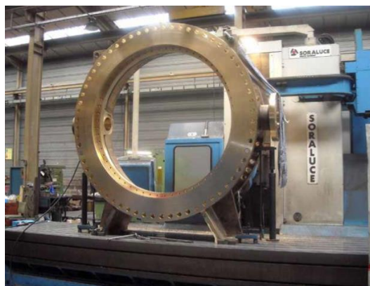
Figura 4. Cuerpo de válvula [6].
