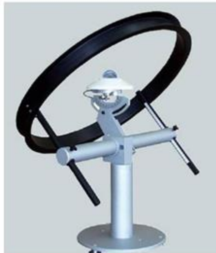
Figura 22: Piranómetro con banda de sombra para medir la radiación
