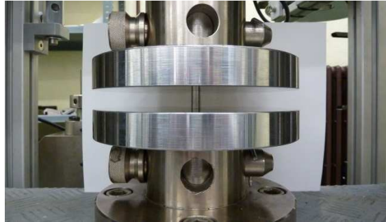
Figura 4.1. Ensayo de compresión entre plataformas plano-paralelas.
