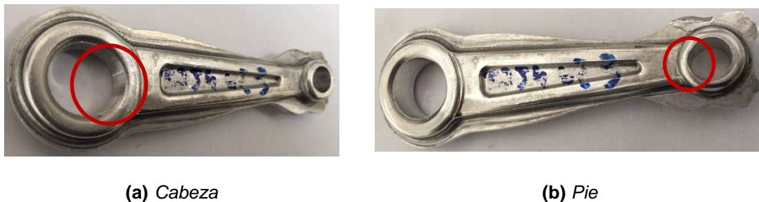
Figura 7.17. Desgaste en una biela de AA5083-N2.
