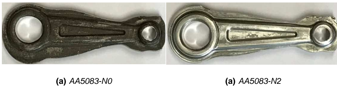
Figura 7.18. Bielas una vez ensayadas.
