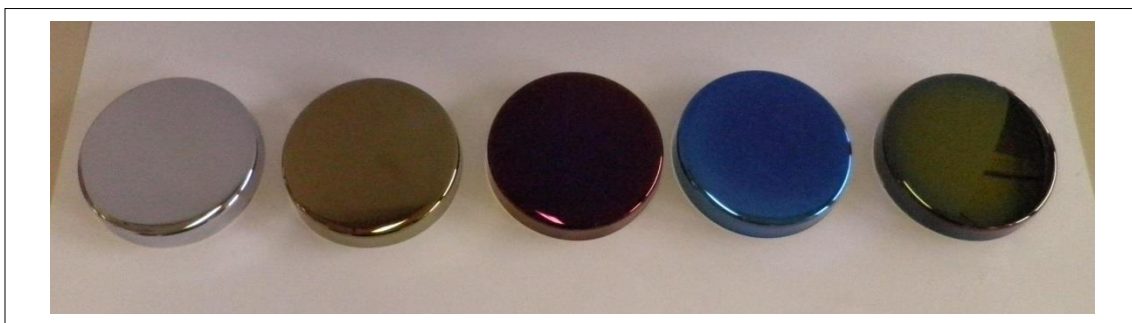
Figura 5: Colores obtenidos por interferencia óptica mediante la deposición de capas PVD de diferente espesor, sobre sustratos de latón cromado.
