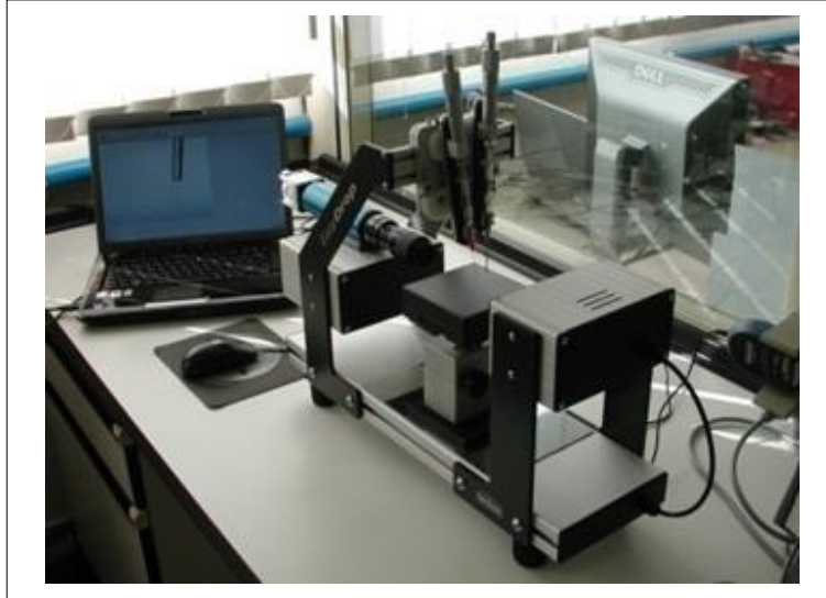
Figura 38: Equipo utilizado para la medición del ángulo de contacto.
