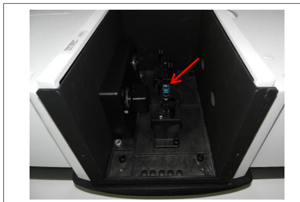
Figura 39: Celda con la disolución de azul de metileno colocada en el espectrofotómetro UV-VIS.
