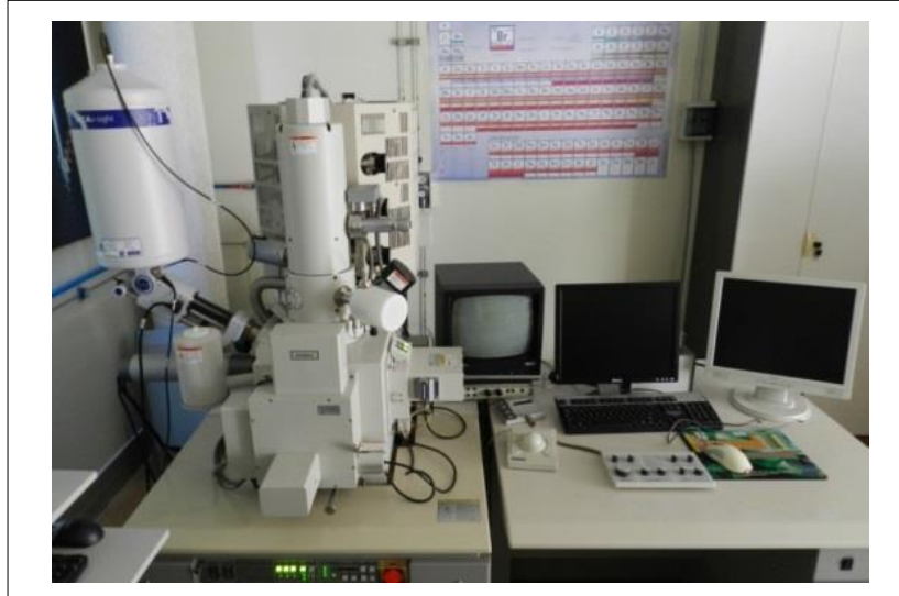
Figura 27: Microscopio electrónico HITACHI S4800 utilizado en la tesis.
