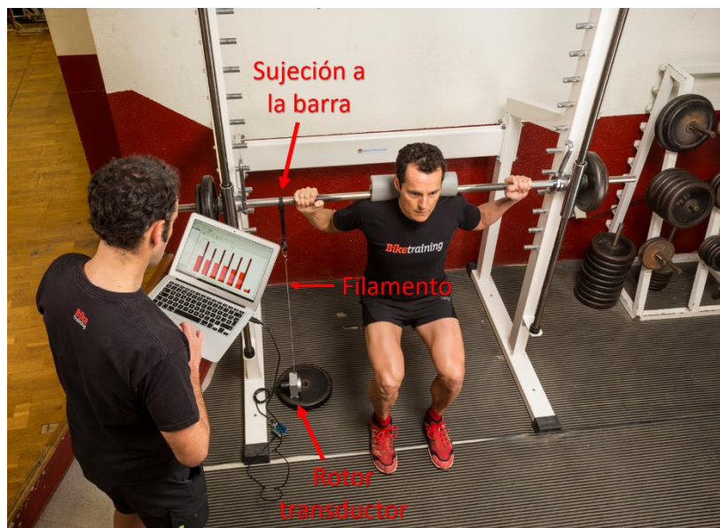
Figura 4-5 Ejemplo de uso de un encoder lineal en sentadilla trasera [6]
