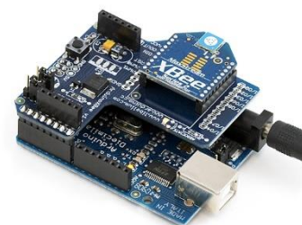
Figura 6-3 Arduino UNO, Shield y modulo Xbee [16]
