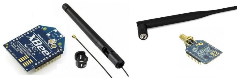
Figura 6-5 Ejemplos de conexión de antenas en los puertos U.FL y RP-SMA [18][19]
