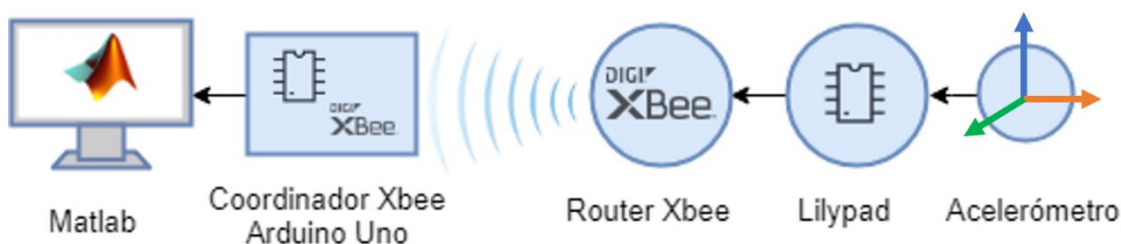
Figura 9-1 Esquema de sistema punto a punto
