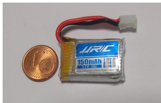
Figura 10-3 Batería de dron de pequeñas dimensiones.
