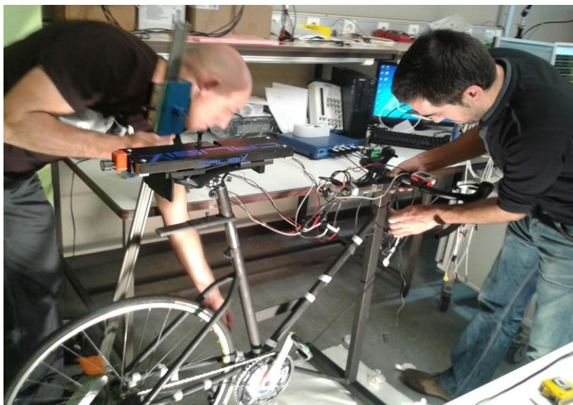
Figura 12 Ajuste del cicloergómetro a las medidas de cada ciclista con el medidor Calibix®
