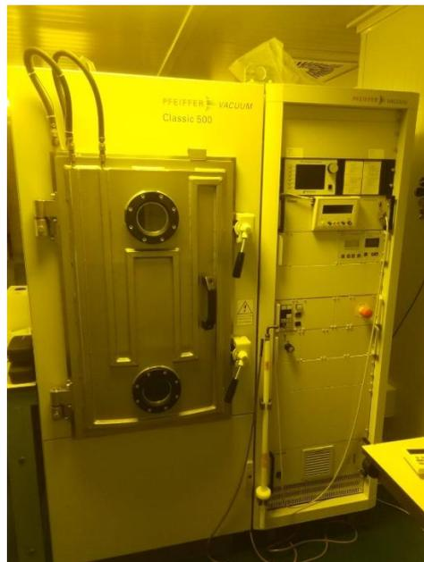
Figura 5-4 Evaporador de haz de electrones usado en este trabajo
