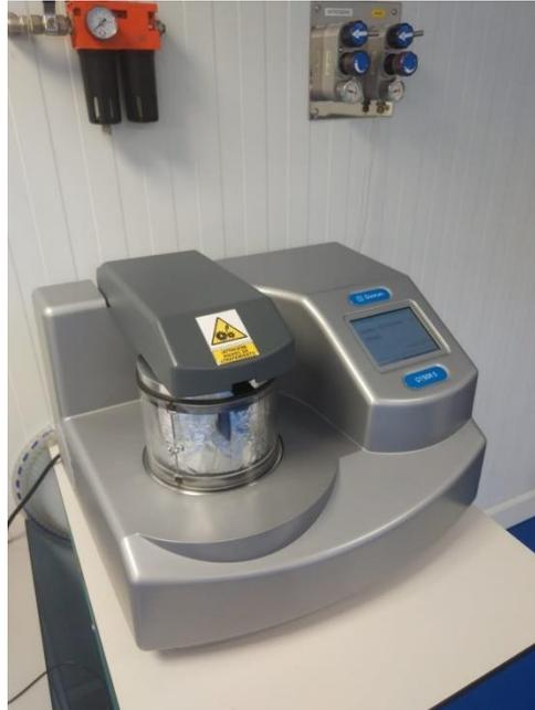
Figura 5-10 Metalizadora usada en este proyecto
