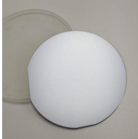
Figura 4-1 Oblea de silicio usado como sustrato
