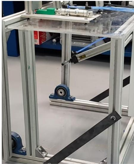
*Ilustración 10: Perfil vertical de apoyo y metacrilato.*
