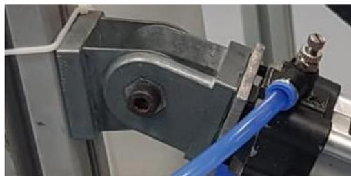
*Ilustración 14: Fijación trasera del actuador neumático.*
