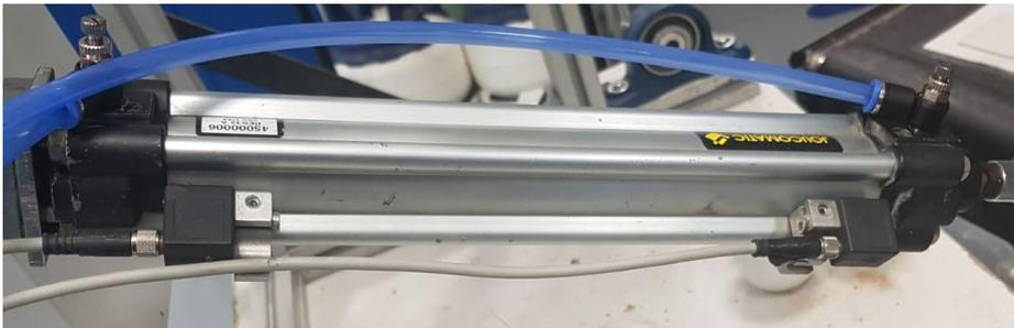
*Ilustración 34: Sensores sobre la carcasa del pistón.*
