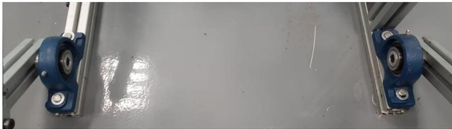
*Ilustración 13: Rodamientos con silletas sobre el marco de la base.*
