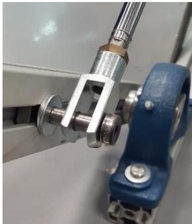
*Ilustración 15: Fijación del vástago y el marco.*
