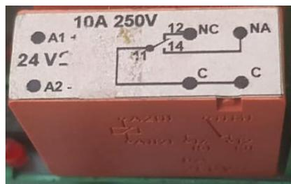
Ilustración 30: Relé utilizado en el prototipo.
