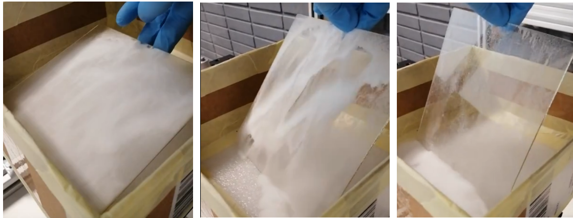
Figura 66: Muestra de vidrio virgen después de las pruebas de ensuciamiento con Sílice.
