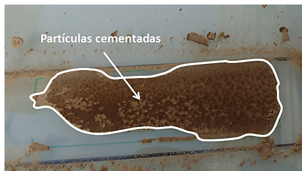
Figura 7: Partículas cementadas en una prueba de abrasión.
