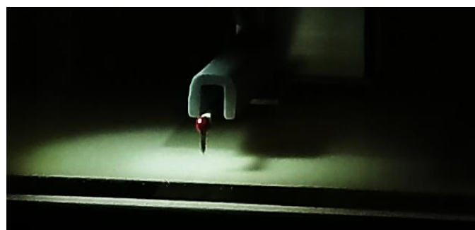
Figura 46: Estilite de 2 \mu\text{m} del perfilómetro.
