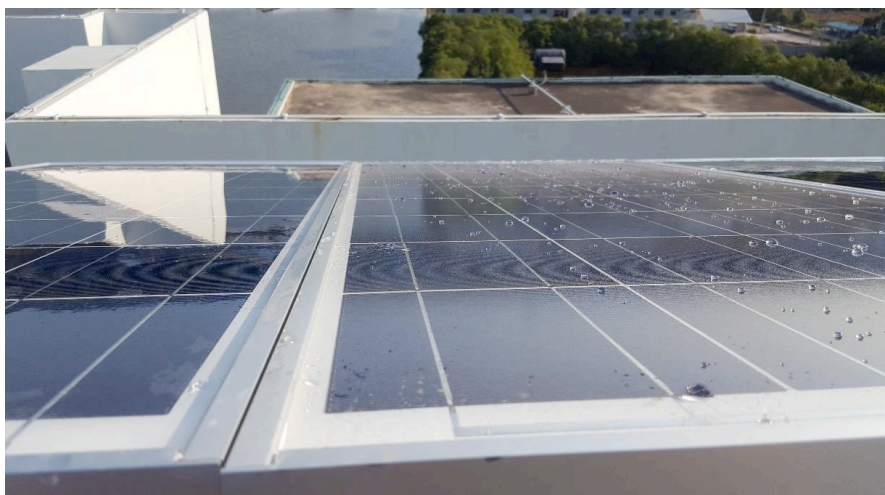
Figura 9: Dos módulos fotovoltaicos con diferentes tratamientos. A la izquierda hidrófilo y a la derecha hidrófobo. [14]
