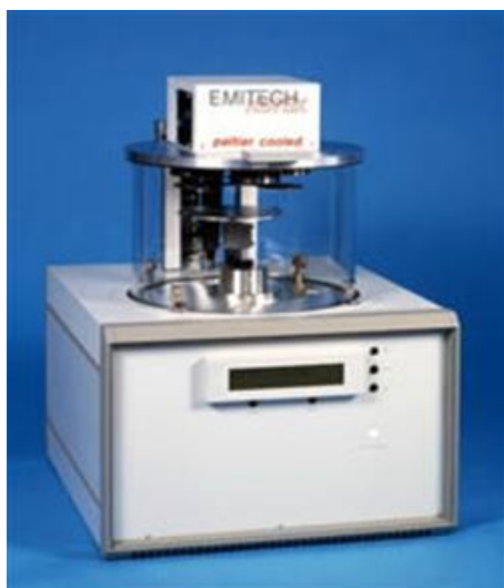
Figura 3. Equipo de deposición del material. a) Sputter K675XD de Quorum b) Cámara de vacío del Sputter
