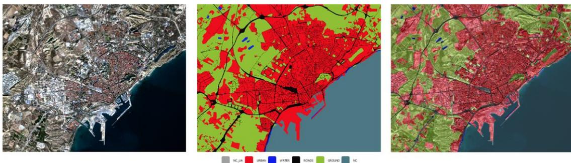
Figura 1 Imagen Séntinel-2 del puerto de Alicante, junto a una posible clasificación generada con SIWUAC
