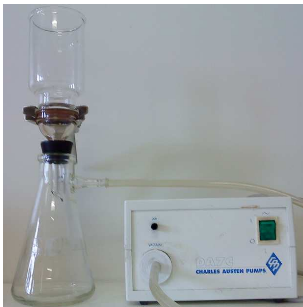
Ilustración 15: Sistema de filtrado de vino
