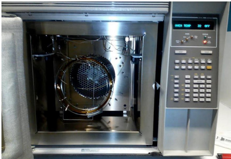
FIGURA 13. Cromatógrafo de gases empleado.
