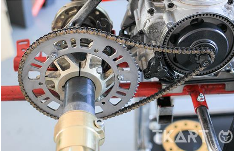
Figura 28 - detalle del montaje de la corona. Fuente: https://www.tkart.it/es/
