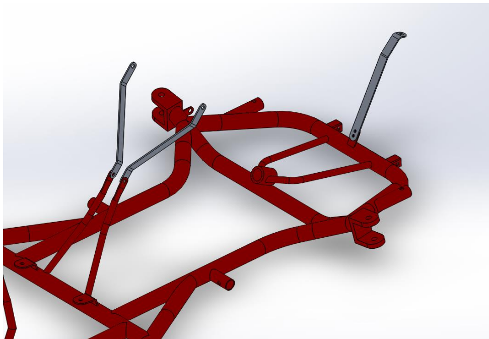
Figura 95 - soportes panel frontal. Fuente: propia.
