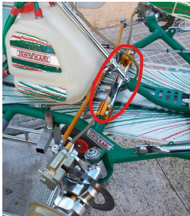
Figura 16 - barra de torsión instalada en un chasis TONY KART. Fuente: http://www.mercadoracing.org
