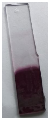
Figura 4.1.3.2.: Fotografía para mostrar el aspecto de uno de los portas originales con recubrimiento de PAH/PAA-AuNPs al ser sumergido durante 10 minutos en H_2O_2 10000 ppm (1% de pureza).
