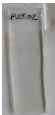
Figura 4.1.1.2.: Fotografía para mostrar el aspecto de uno de portas originales con recubrimiento de PAH/PSS-AgNPs al ser sometido a una inmersión durante 10 minutos en H_2O_2 10000 ppm (1% de pureza).
