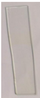
Figura 4.1.1.5.: Fotografía para mostrar el aspecto del porta extraído del horno del laboratorio tras ser sumergido durante 30 minutos en H_2O_2 10000 ppm (1% de pureza).
