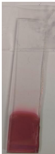
Figura 4.1.3.4.: Fotografía para mostrar el aspecto de uno de portas originales con recubrimiento de PAH/PAA-AuNPs al extraerse tras ser introducido durante 2 horas a 450° C en el horno del laboratorio.
