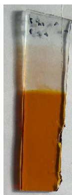
Figura 4.1.2.2.: Fotografía para mostrar el aspecto de uno de portas originales con recubrimiento de PAH/PAA-AgNPs al ser sometido a una inmersión durante 10 minutos en H_2O_2 10000 ppm (1% de pureza).
