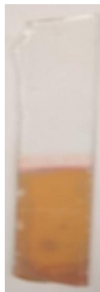
Figura 4.1.4.4.: Fotografía para mostrar el aspecto de uno de portas originales con recubrimiento de (PAH/PAA-AuNPs) + (PAH/PAA-AgNPs) al extraerse tras ser introducido durante 2 horas a 450° C en el horno del laboratorio.
