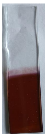
Figura 4.1.4.2.: Fotografía para mostrar el aspecto de uno de portas originales con recubrimiento de (PAH/PAA-AuNPs) + (PAH/PAA-AgNPs) al ser sumergido durante 10 minutos en H_2O_2 10000 ppm (1% de pureza).
