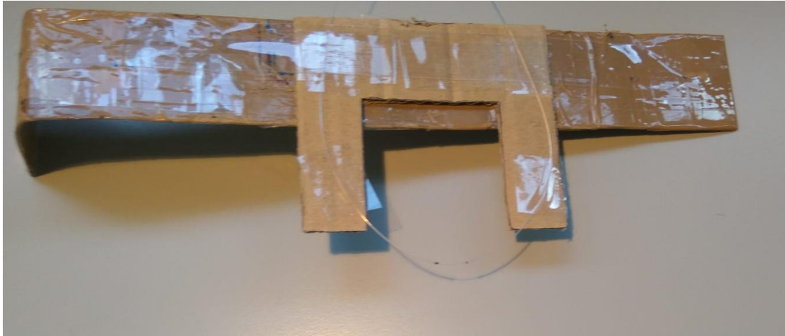
Figura 3.4.3.: Imagen de un ejemplo de U de cartón para sostener la fibra óptica.
