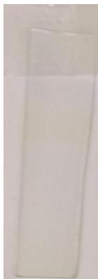
Figura 4.1.1.4.: Fotografía para mostrar el aspecto de uno de portas originales con recubrimiento de PAH/PSS-AgNPs al extraerse tras ser introducido durante 2 horas a 450° C en el horno del laboratorio.
