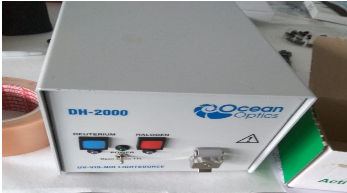
Figura 3.4.8.: Imagen de la fuente de luz DH-2000 de Ocean Optics. Cuenta con lámpara de luz de deuterio y con lámpara con luz halógena.
