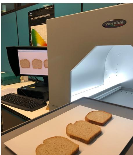
Figura 11. Preparación de las muestras de pan en DigiEye
