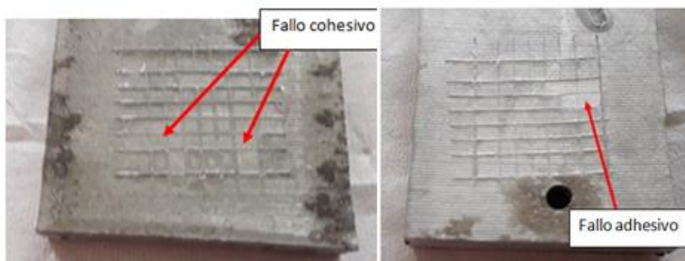
Figura 5.42a: Probeta nº 21, espesor de 200 \mu\text{m} y 0,1% polianilina. Levanta las capas. Categoría "2".
