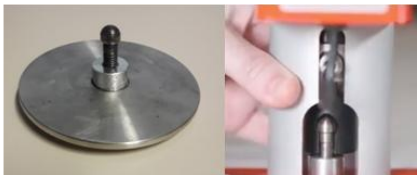
Figura 4.30: Colocación de disco de apoyo sobre probeta y amarre de la sufridera al equipo de tracción mediante el perno.
