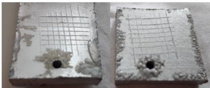
Figura 5.41a: Probeta nº 17, espesor de 200 \mu\text{m} y sin cargas. Categoría "0".
