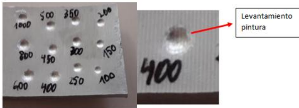
Figura 5.7: Deformaciones producidas con un punzón de 5 mm.
