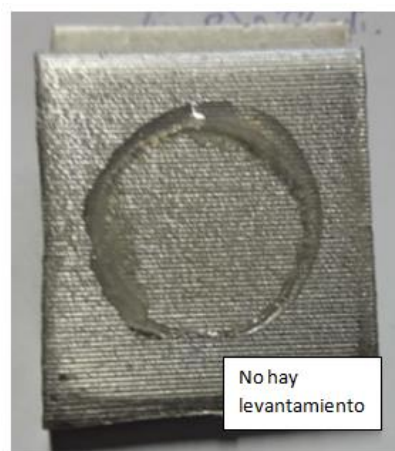
Figura 5.19d: Probeta de espesor 100 \mu\text{m} y 0,5% de polianilina. Fuerza de tracción de 214 kg (6,7 MPa). No hay levantamiento de pintura.
