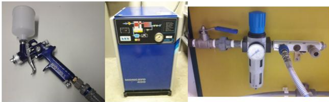
Figura 4.10: De izquierda a derecha: pistola aerógrafa, compresor y toma de aire.
