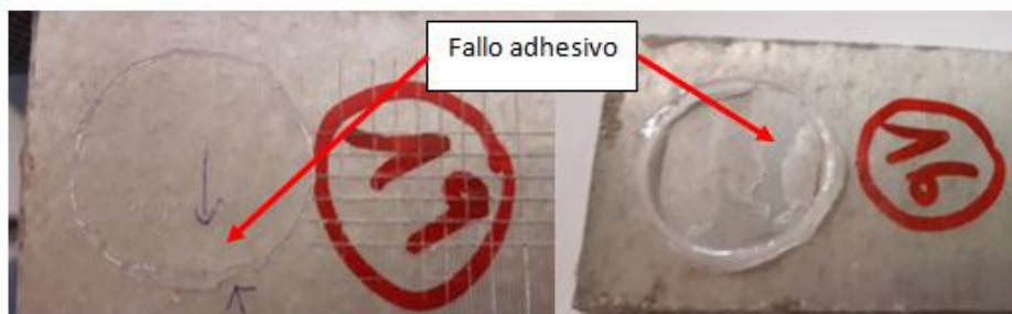
Figura 5.46a: Probeta nº 19, espesor de 100 \mu\text{m} y sin cargas. Carga de rotura 198 kg (6,18 MPa). Fallo adhesivo.
