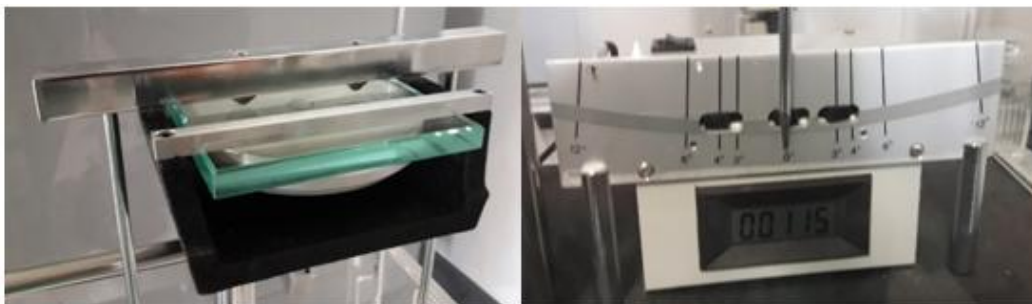
Figura 4.15: A la izquierda colocación del vidrio (patrón) sobre portaprobetas y a la derecha ajuste del "cero".
