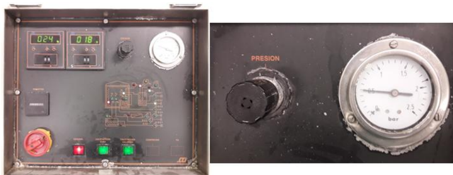
Figura 4.35: Pupitre y manómetro de cámara de niebla salina. Presión calderín de 0,5 bar.
