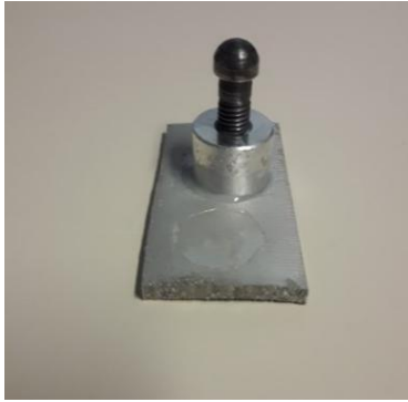
Figura 4.29: Sufridera adherida en una probeta.
