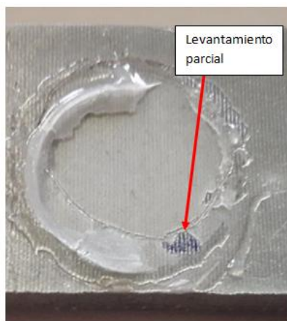
Figura 5.19c: Probeta de espesor 200 \mu\text{m} y 0,1% de polianilina. Fuerza de tracción de 258 kg (8 MPa). Levanta parcialmente, <10%.
