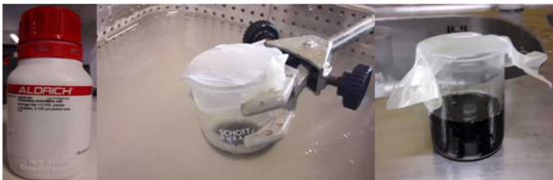
Figura 4.11: De izquierda a derecha: bote de polianilina, mezcla de PU y polianilina en baño de ultrasonidos y mezcla sonicada.
