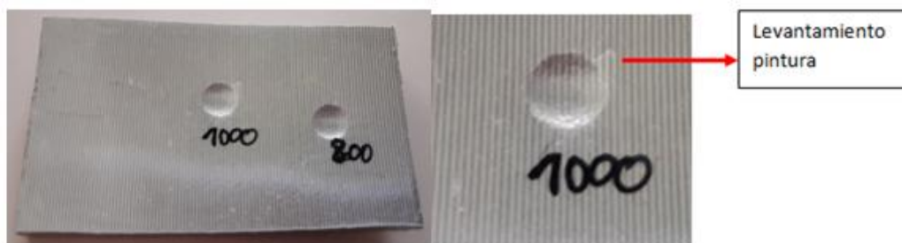
Figura 5.10: Deformaciones producidas con un punzón de 20 mm. II.
