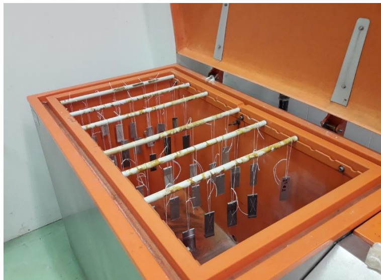
Figura 4.34: Colocación de probetas en cámara.
