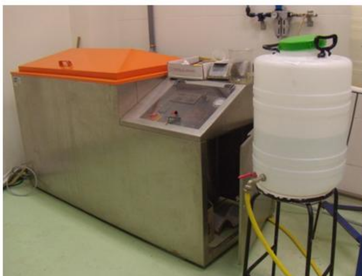
Figura 4.32: Cámara de niebla salina.
