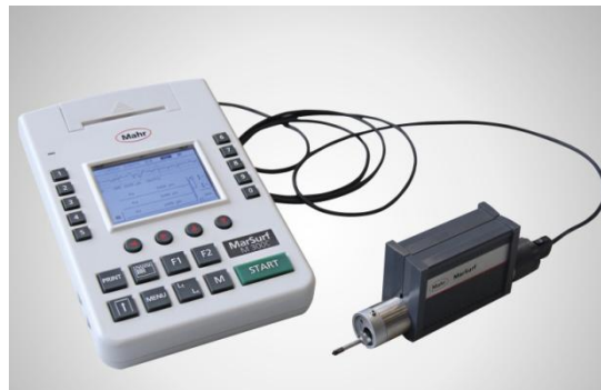
Figura 4.6: Rugosímetro empleado en las mediciones. Marca Mahr y modelo MarSurf-300.
