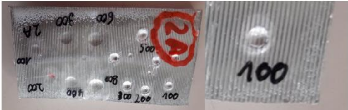
Figura 5.12: Deformaciones producidas con un punzón de 5 mm. Probeta desengrasada.
