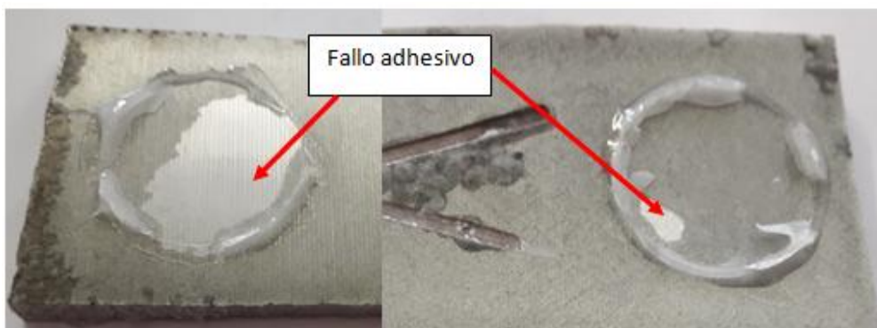
Figura 5.46c: Probeta nº 45, espesor de 50 \mu\text{m} y 0,5% polianilina. Carga de rotura 134 kg (4,18 MPa). Fallo adhesivo.
