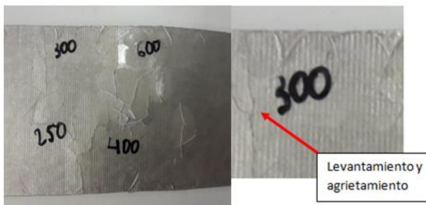
Figura 5.11: Deformación producida con un punzón de 20 mm en cara en contacto con matriz.
