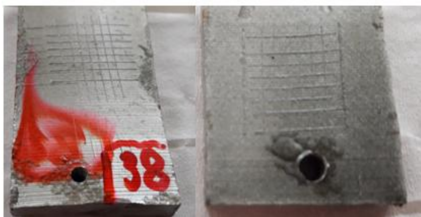
Figura 5.41c: Probeta nº 38, espesor de 100 \mu\text{m} y 0,1% polianilina. Categoría "0".
