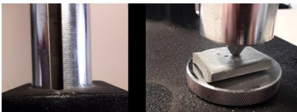
Figura 4.22: "Cero" de escala graduada y ensayo sobre probeta.
