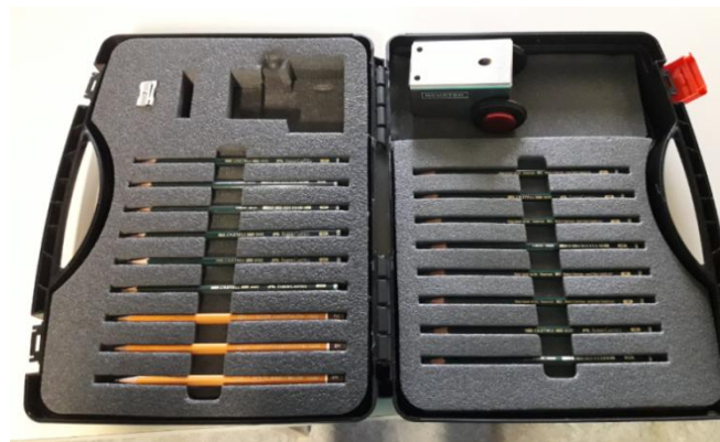
Figura 4.17: Durómetro de lápices.
