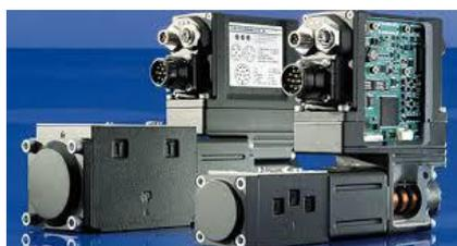
La válvula proporcional tiene dos conectores eléctricos, uno de alimentación de 24V para la electrónica de potencia que mueve el solenoide y un conector M12 para la alimentación a 24V del control y la comunicación CANopen.
