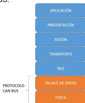
Las especificaciones relativas al enlace de datos y capa física del CAN Bus están definidas en la ISO 11898. Donde se define la comunicación transmitida entre dispositivos a través de la red.
