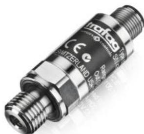
El sensor de presión Trafag, tiene un conector M12, para la alimentación a 24V y para los canales CAN-H, CAN-L y GND para la conexión al CAN bus.
