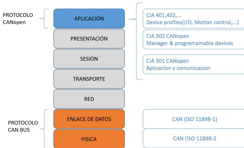
CANopen se puede explicar dividiendo el protocolo en seis partes, que definen como se lleva a cabo la comunicación en la red y como se organiza la información en los dispositivos conectados a ella. La siguiente figura resume el protocolo en sus componentes principales.
