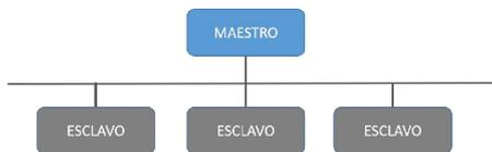
**Modelo de comunicación:** Definidos tres Modelos de comunicación entre dispositivos. Maestro/Esclavo, Cliente/Servidor y productor/consumidor.
