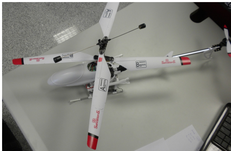
Ilustración 10-6: Helicóptero visto desde arriba, ver situación de la barra estabilizadora.
