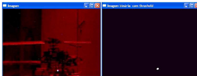
Ilustración 4-24(17): Algoritmo de procesamiento de la imagen: al final sólo interesa ver la posición del Led.
