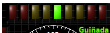
Ilustración 7-14: Indicador de la potencia de guiñada. En función de la inclinación lateral se encienden los led's.
