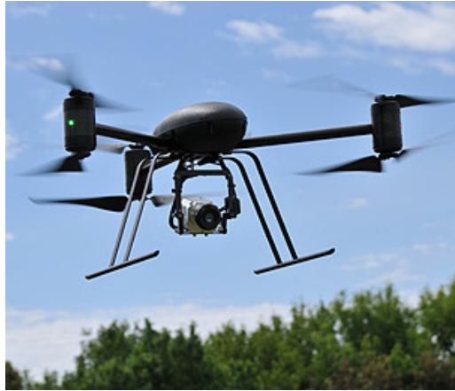
Ilustración 2-3: Draganflyer X6, variante de un quadrotor con tres pares de rotores.
