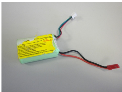
Ilustración 4-112: Batería de Litio - Polímero original del helicóptero.
