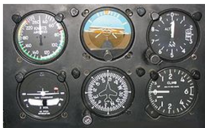
Ilustración 4-21: (9)Panel de instrumentación típico de un avión. De izquierda a derecha y de arriba a abajo: indicador de la velocidad del viento, horizonte artificial o indicador de actitud, altímetro, coordinador de giro, indicador de rumbo e indicador de velocidad vertical.
