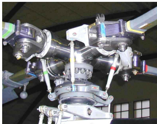
Ilustración 4-84: Encastre del rotor de un helicóptero convencional. Detalle del mecanismo. Extraído de los apuntes de helicópteros de I. Técnica Aeronáutica de la UPM.
