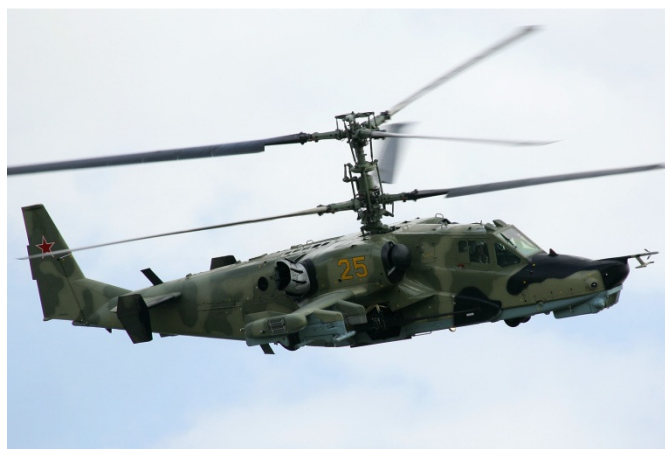
Ilustración 4-87: (9) Helicóptero militar coaxial Kamov Ka-50. Ver la ausencia de rotor trasero.
