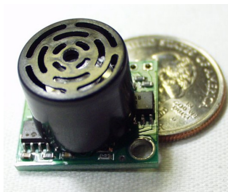
Ilustración 4-114: Sensor EZ4 empleado para medir la altura.
