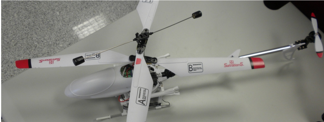
Ilustración 4-91: Helicóptero del PFC con la barra estabilizadora en un primer plano.
