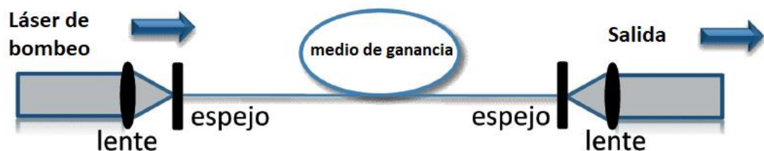
Figura 1-11 Configuración básica de un láser de fibra óptica.
