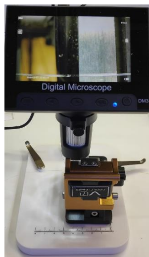
Figura 3-5 Estabilización de la fibra a cortar mediante cortador de fibra óptica.
