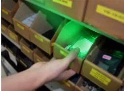
*Imagen 51: Ejemplo del método Pick By Beam*
