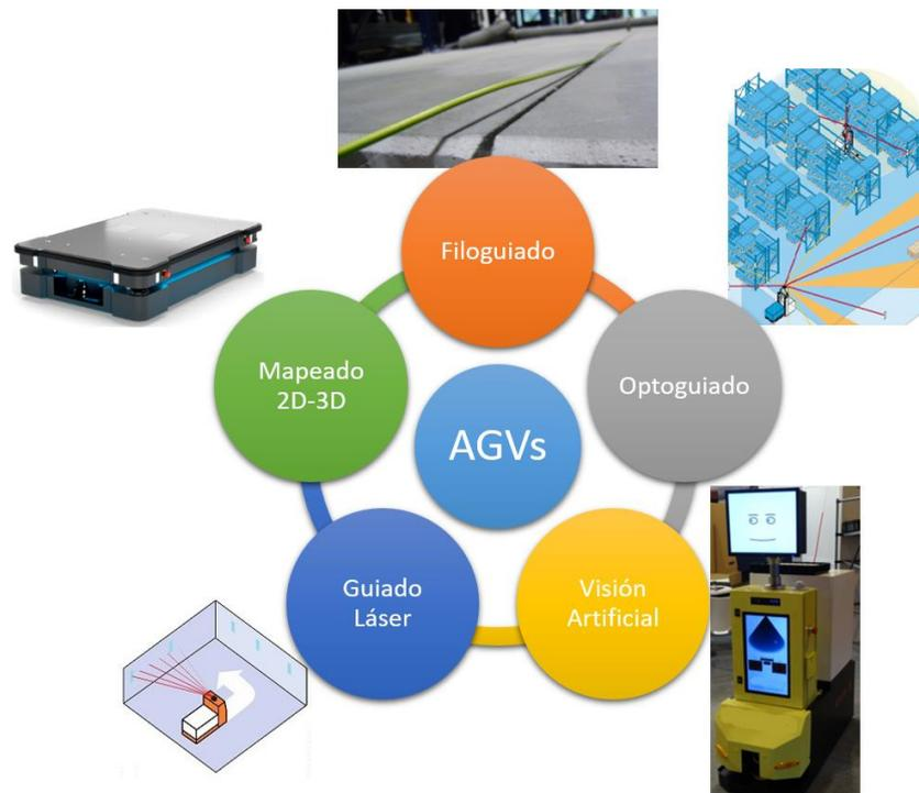
Imagen 24: Tipos de sistemas de navegación de un AGV
