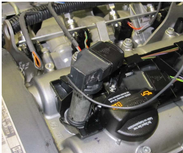
Figura 6.5.6. Situación de la bujía instrumentada
