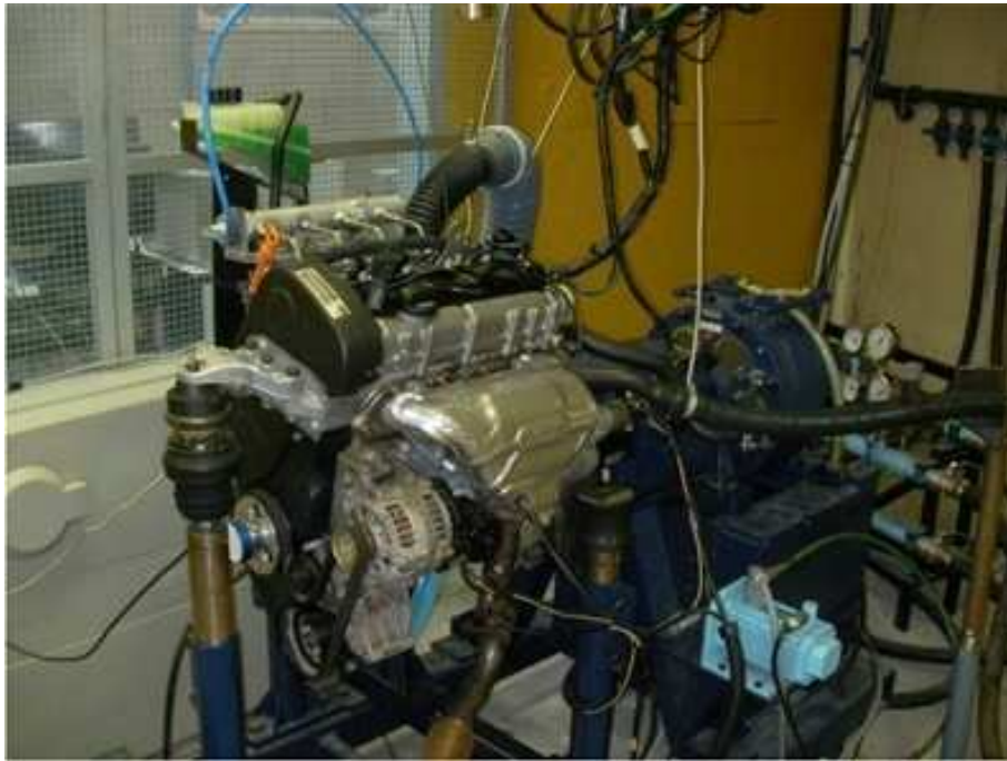
Figura 6.5.3. Motor en el banco de ensayos
