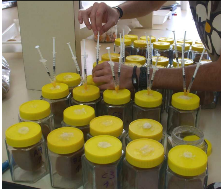
Figura V. Incubación de los frutos y extracción de muestras para la medición de etileno
