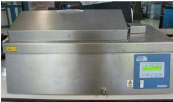
Figura 3.1. Baño termostático empleado para tratar térmicamente la solución de WPI
