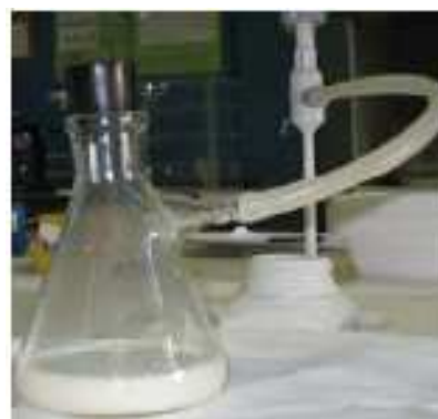
Figura 3.3. Desgasificación a vacío de la muestra
