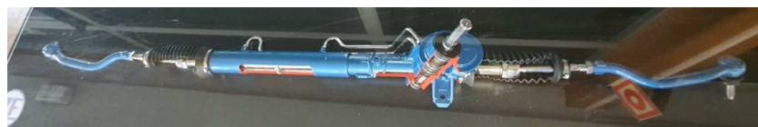
Ilustración 5: Dirección de cremallera PR&P - VX62
