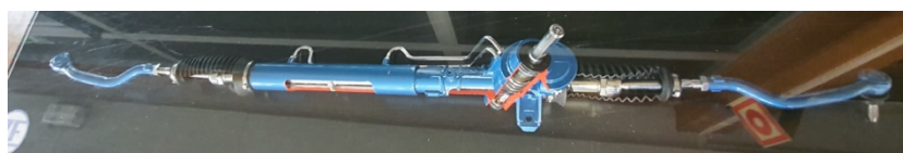
Ilustración 1: Dirección de cremallera PR&P - VX62
