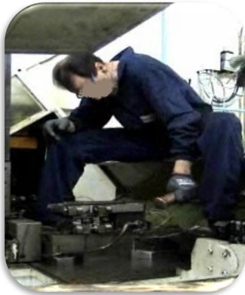
Foto: operario sentado en altura desatascando
