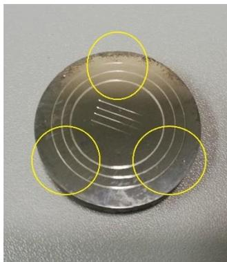
**Figura 52. Probeta ensayada con 3 zonas de medida seleccionadas.**
