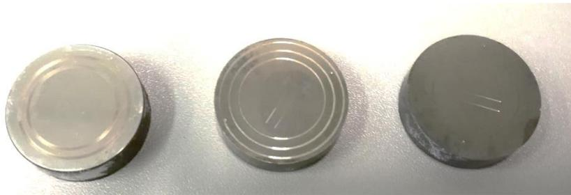
**Figura 60. Probetas de vanadis-4 después de los ensayos. De izquierda a derecha: vanadis-4 sin recubrir, vanadis-4 con WC:C y vanadis-4 con ta-C.**
