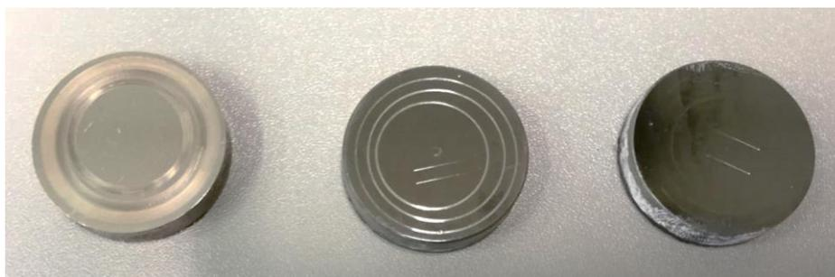
Figura 67. Probetas de K-360 después de los ensayos. De izquierda a derecha: K-360 sin recubrir, K-360 con WC:C y K-360 con ta-C.
