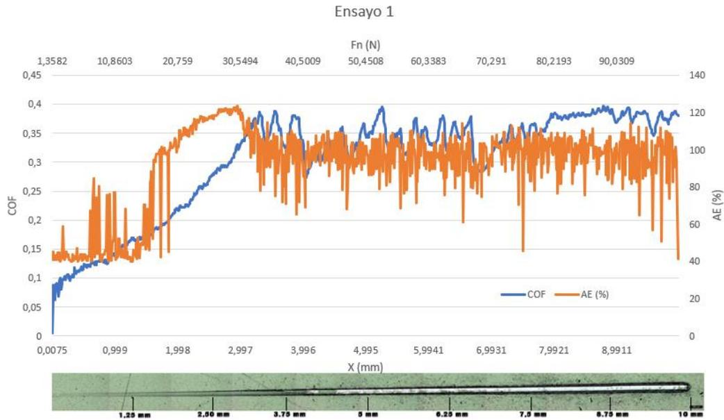
Figura 40. Gráfica resultante del primer scratch test para la probeta de vanadis 4 recubierta con ta-C y su huella.
