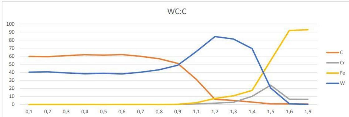
**Figura 29. GDOES del recubrimiento de WC:C [77].**
