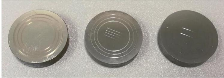
**Figura 74. Probetas de vancron después de los ensayos. De izquierda a derecha: vancron sin recubrir, vancron con WC:C y vancron con ta-C.**
