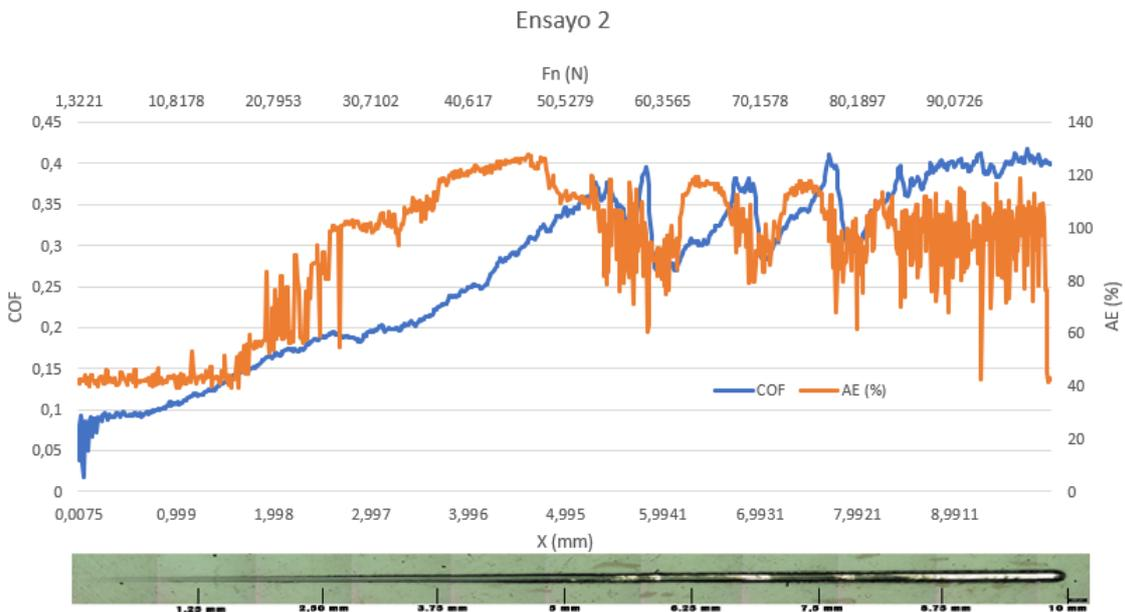
**Figura 49. Gráfica resultante del segundo scratch test para la probeta de vancron recubierta con ta-C y su huella.**
