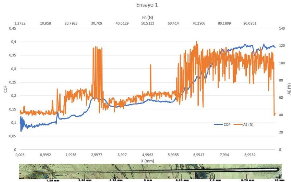
Figura 46. Gráfica resultante del primer scratch test para la probeta de vancron recubierta con WC:C y su huella.
