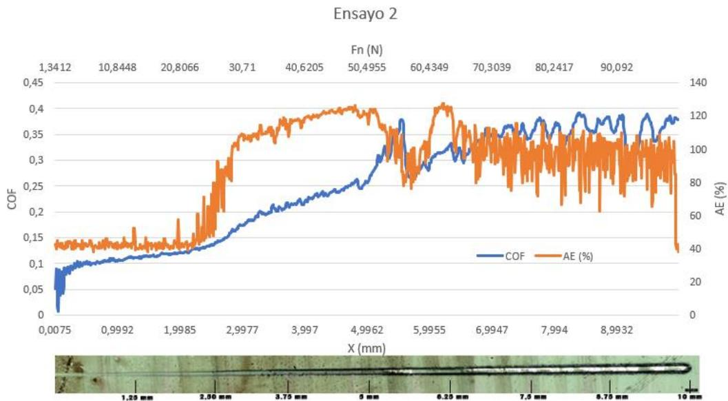
Figura 45. Gráfica resultante del segundo scratch test para la probeta de K-360 recubierta con ta-C y su huella.
