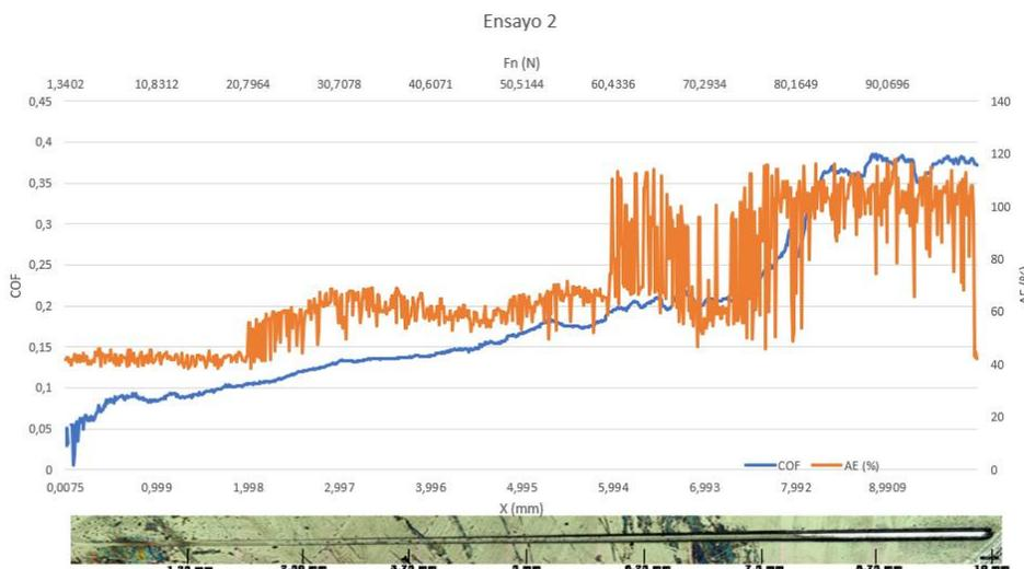
Figura 47. Gráfica resultante del segundo scratch test para la probeta de vancron recubierta con WC:C y su huella.
