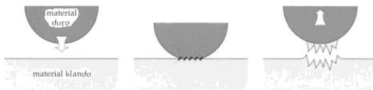
**Figura 12. Esquema del mecanismo de desgaste adhesivo [76].**
