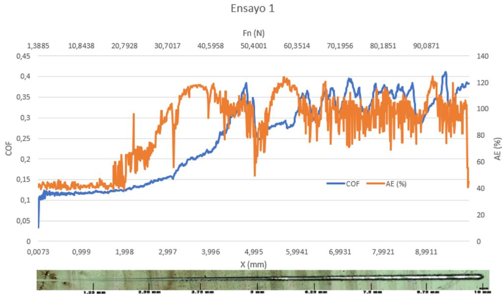
Figura 44. Gráfica resultante del primer scratch test para la probeta de K-360 recubierta con ta-C y su huella.
