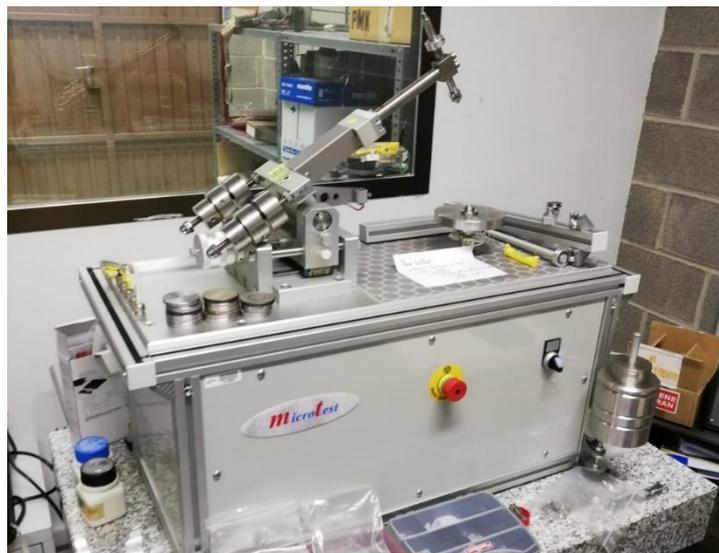
**Figura 24. Tribómetro Pin on Disk utilizado en este trabajo.**
