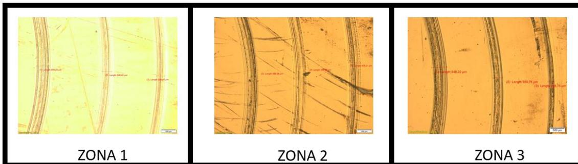
**Figura 70. Imágenes obtenidas mediante microscopía óptica para la muestra de vancron con WC:C en 3 zonas diferentes.**
