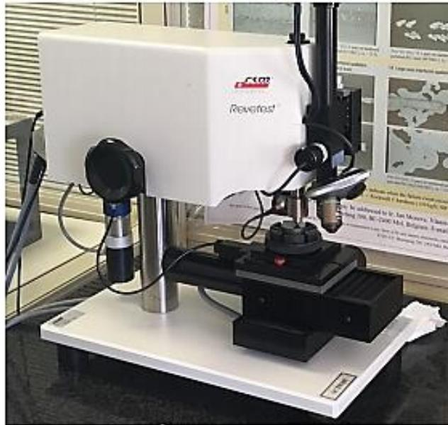
*Ilustración 21. Equipo para realizar prueba scratch test*
