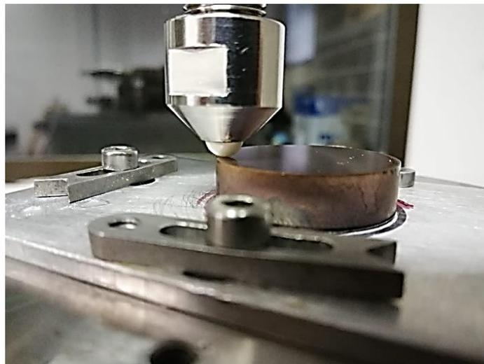
*Ilustración 22. Bola de alúmina sobre la probeta*
