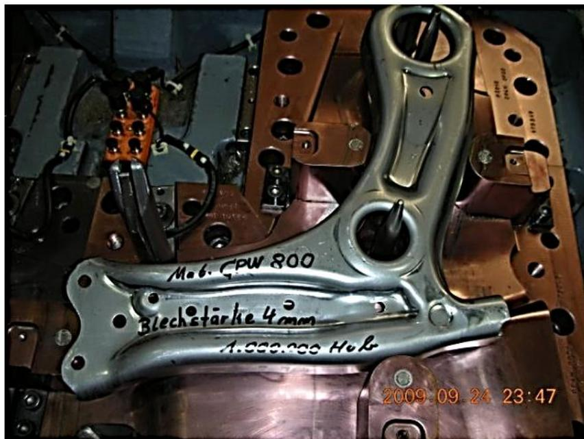
Ilustración 48. Ejemplo 4 de aplicaciones del tratamiento Dúplex. Horquilla. Acero 1.2379
