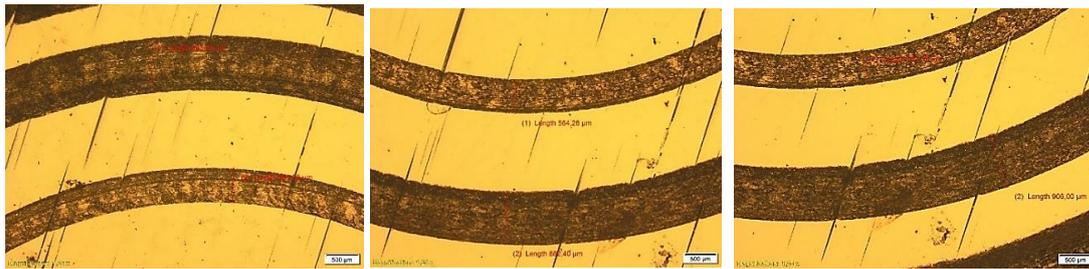
Ilustración 30. Ancho de surco. Probeta 1.2379 R6-R8. Zona 1,2,3
