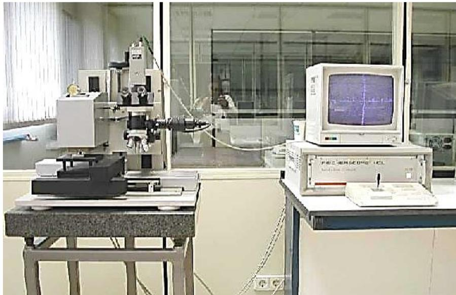
Ilustración 24. Equipo ultra micro durómetro. FISHERSCOPE H100 VP/X-Y. Lab. AIN
