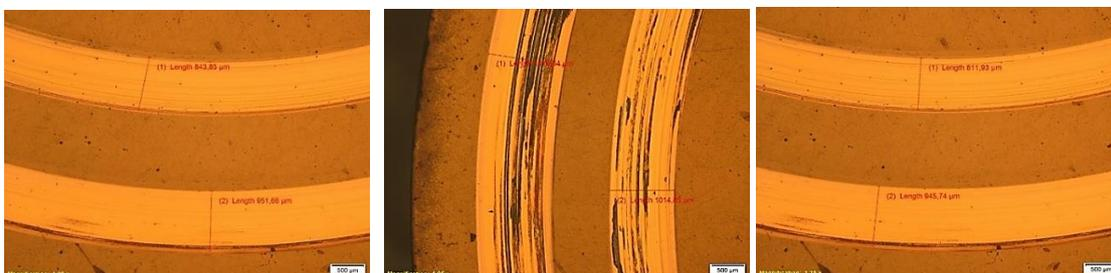
Ilustración 37. Ancho de surco. Probeta 1.2379 Dúplex R10-R12. Zona 1,2,3
