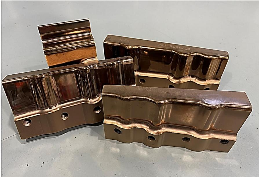
*Ilustración 45. Ejemplo 1. Acero 1.2379 con tratamiento Dúplex. Útil de conformar*
