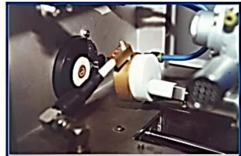
Ilustración 9. Proceso de sputtering (Lámpara de emisión)
