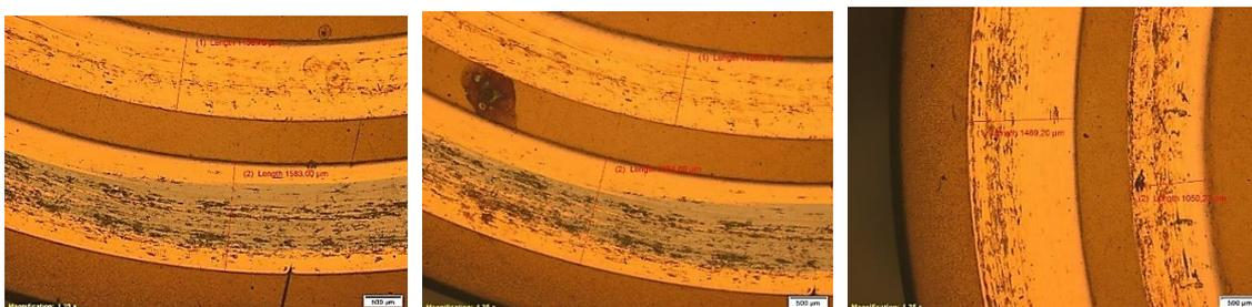
Ilustración 35. Ancho de surco. Probeta 1.2379 R10-R12. Zona 1,2,3 (FR02)
