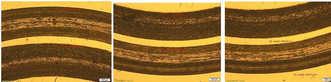
Ilustración 31. Ancho de surco. Probeta 1.2379 R10-R12. Zona 1,2,3
