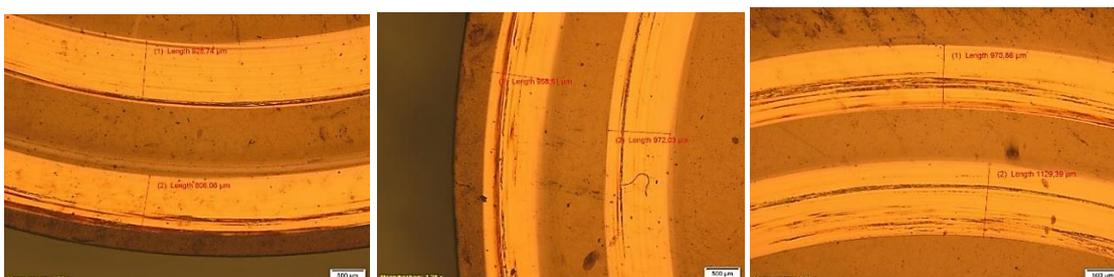
Ilustración 39. Ancho de surco. Probeta Vanadis 4 R10-R12. Zona 1,2,3
