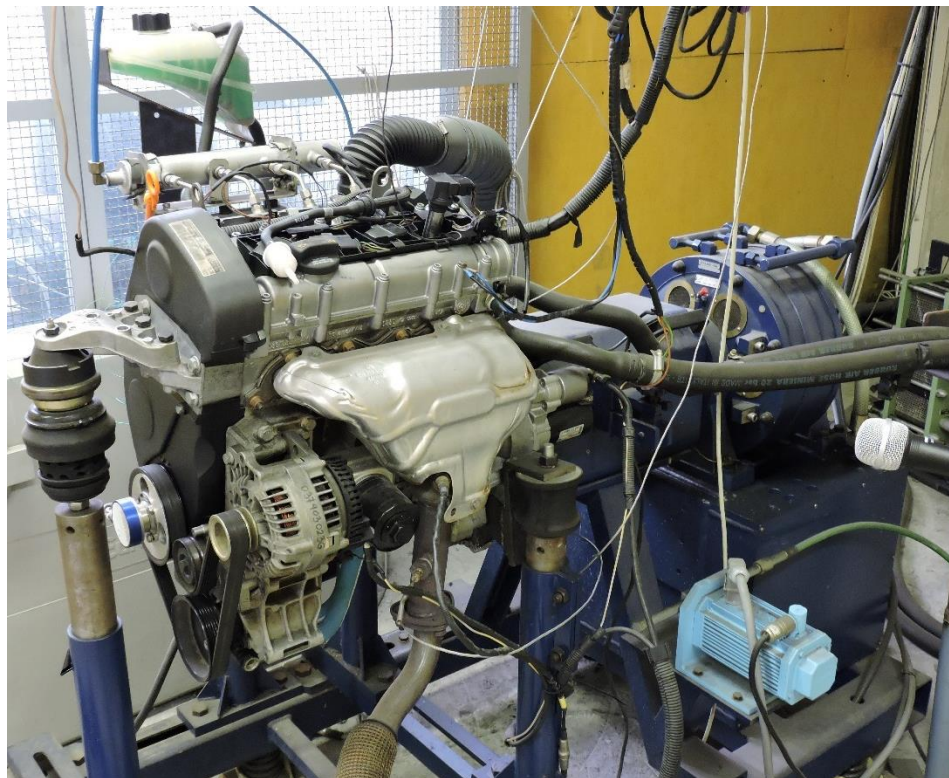
Fig.1 Motor comercial Volkswagen 1,4 L 59 kW
