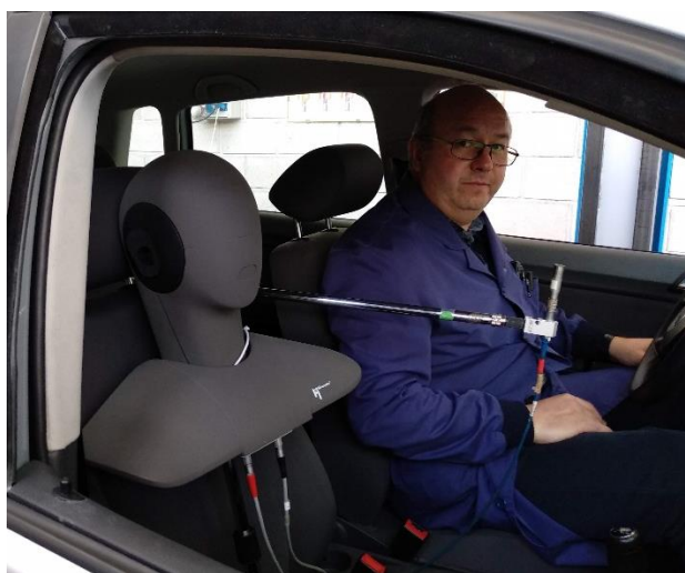
Fig.47 Ensayos de ruido en el habitáculo de un vehículo
