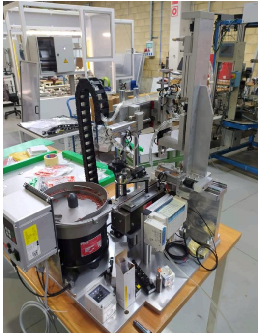
Imagen 37 – Conjunto estación montado y cableado. Fuente:propia
