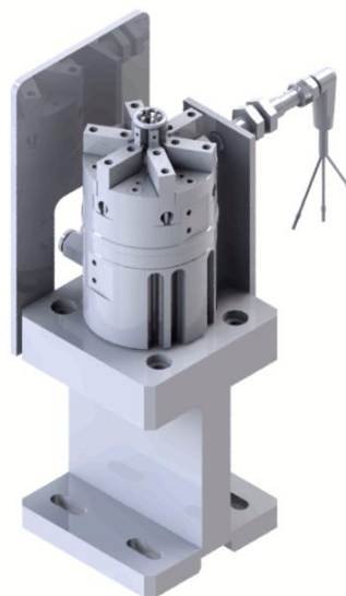
Imagen 24 – Sistema de colocación de juntas modelado. Fuente:propia
