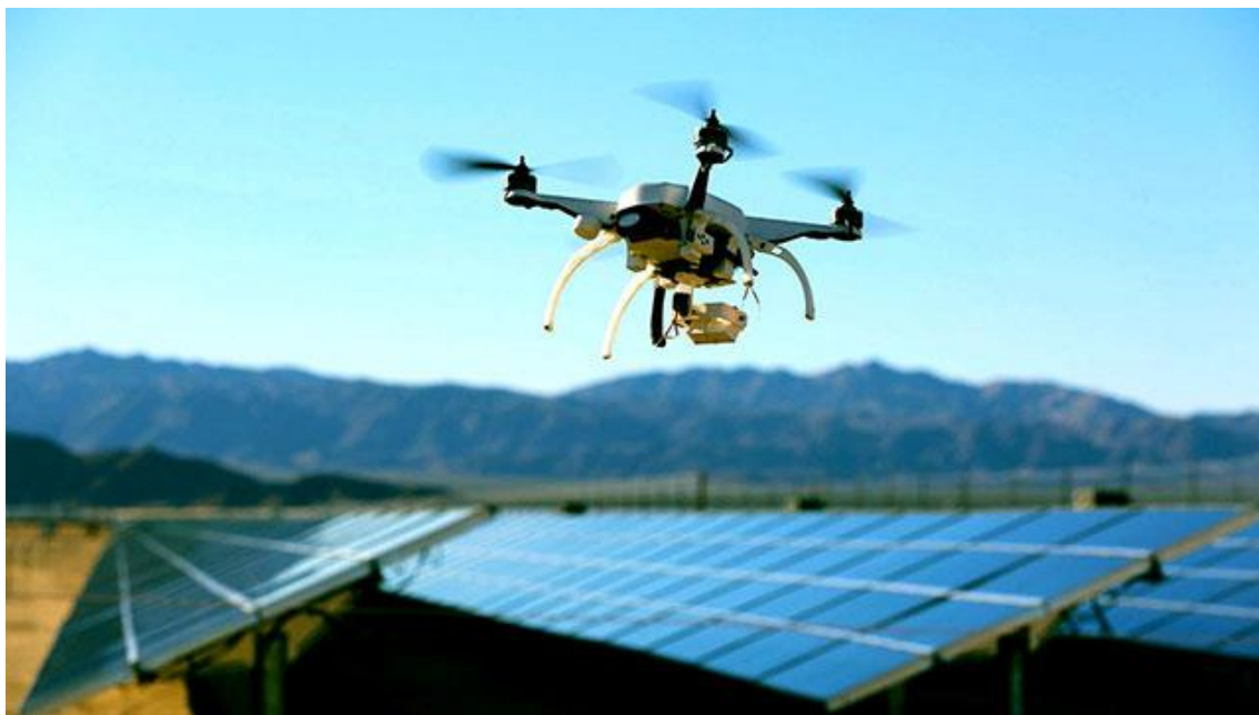
Ilustración 1- UAV para monitorización de paneles fotovoltaicos.
