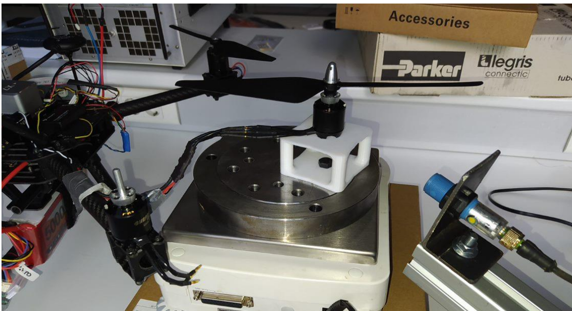
Ilustración 27- Ensayo del empuje de los rotores.
