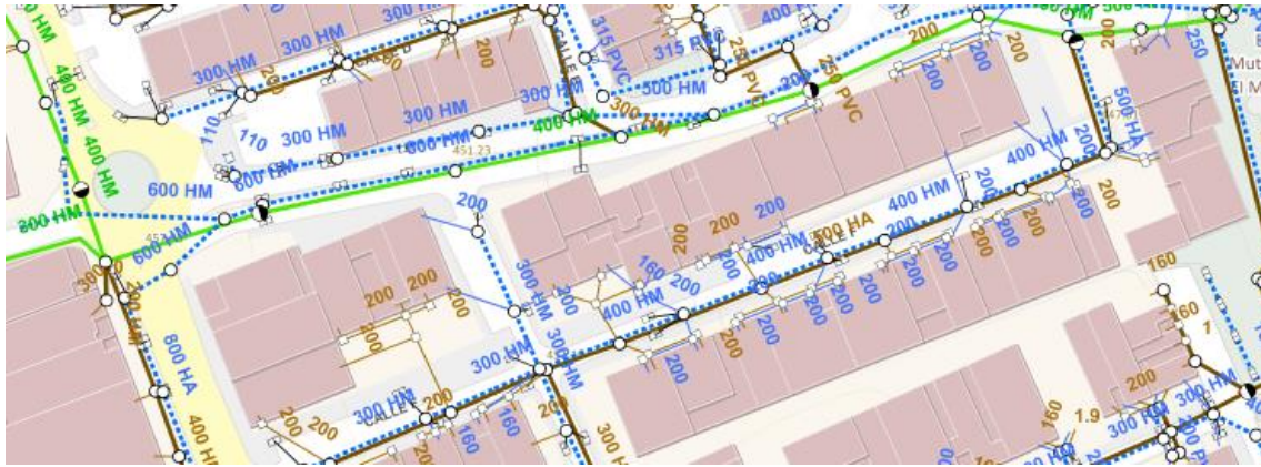
Ilustración 40. Red saneamiento agua MCP.
