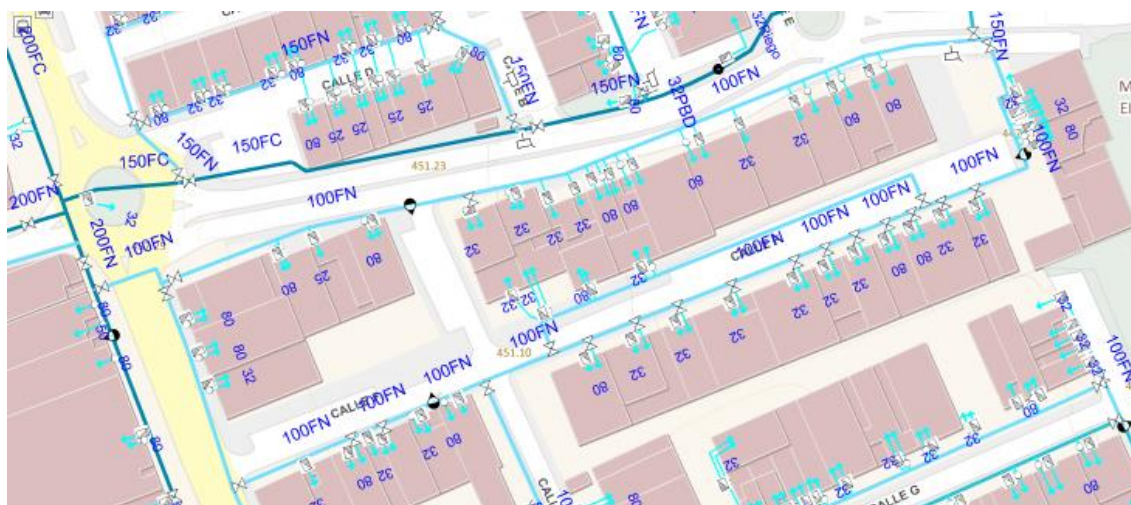
Ilustración 39. Red abastecimiento agua MCP.
