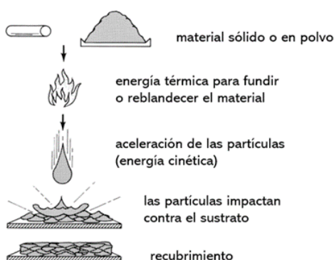
Figura 22. Concepto general del proceso de proyección térmica [24].
