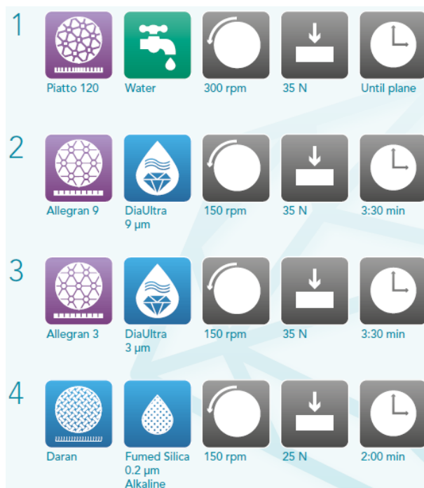
Figura 78. Pasos recomendados para ejecutar el pulido de las muestras con recubrimientos por proyección térmica por plasma con los platos, diamantes, velocidad, fuerza y tiempo, por la compañía Akasel [46].
