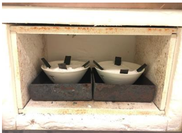
Figura 70. Carga horno Thermolyne Type 6000 Furnace de crisoles de sal ternaria con las muestras 321-1 y 347-1 en el crisol izquierdo; 321-2 y 347-2 en el crisol derecho.
