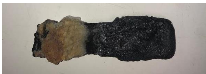
Figura 87. Muestra AISI 347 tras exposición en sales fundidas binaria ( \text{KCl-NaCl} ) extraída del crisol.
