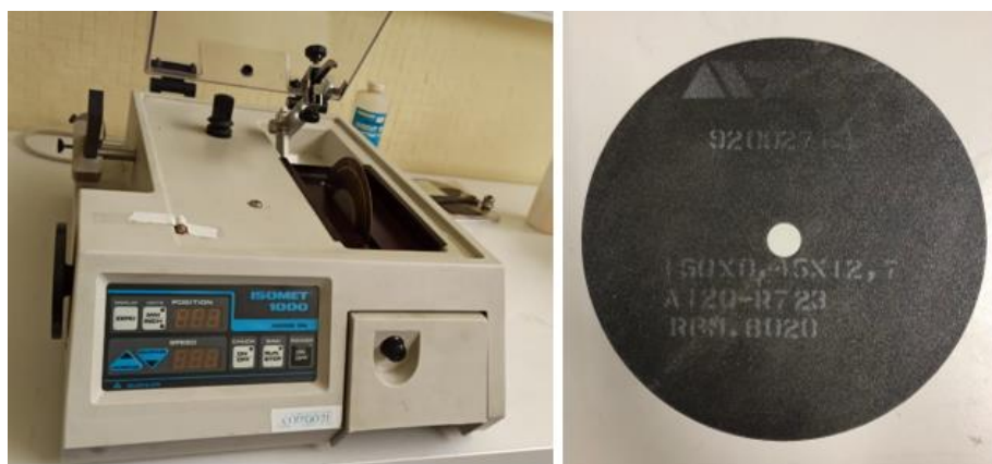
Figura 77. Máquina cortadora Buehler modelo Isomet1000® junto al disco de corte empleado en las muestras con recubrimientos por proyección térmica.
