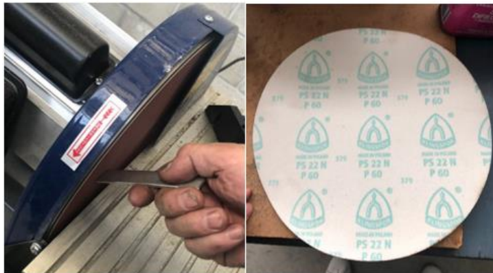
Figura 55. Matado de aristas vivas con su respectiva lijadora (P60).
