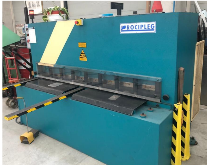
Figura 54. Máquina cizalladora para el corte de los planchones y obtención de las probetas.
