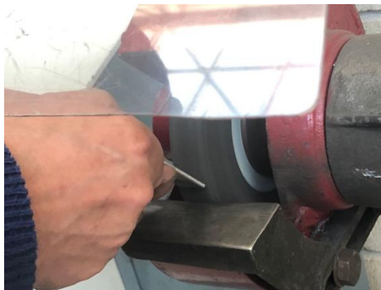
Figura 57. Preparación de las superficies a soldar en doble V mediante una esmeriladora.
