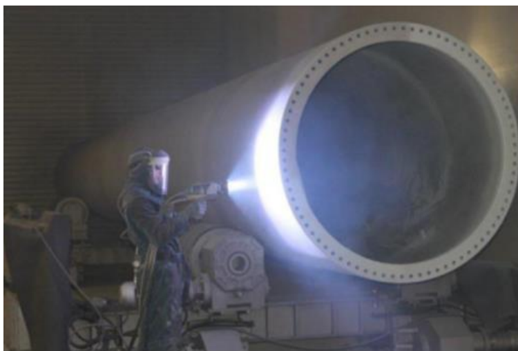
Figura 31. Proyección térmica de zinc en una torre eólica [28].
