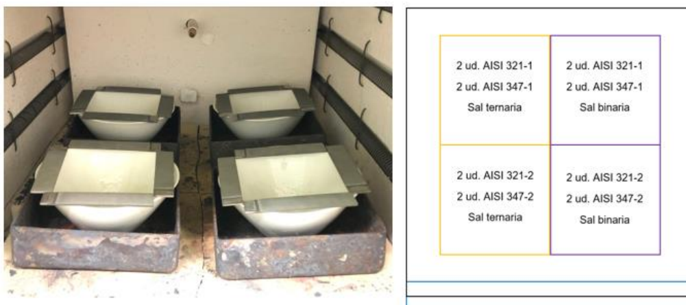
Figura 62. Carga del horno para la preoxidación de las muestras y colocación de las probetas encima de los crisoles.
