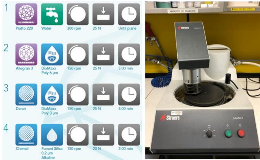
Figura 76. Pasos recomendados para aceros inoxidables para ejecutar el pulido de las muestras por la compañía Akasel [44]. Imagen derecha se muestra la pulidora utilizada de la compañía Struers.
