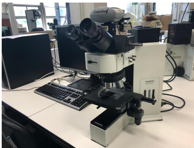
Figura 83. Microscopio óptico OLYMPUS modelo BX60M empleado para la caracterización de todas las muestras.
