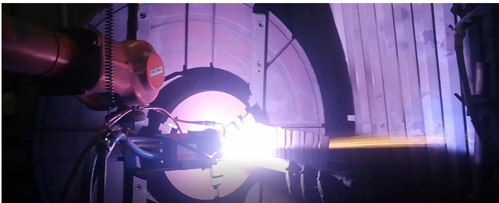
Figura 61. Proyección del recubrimiento Metco 443NS (Nº id. 2) mediante APS.
