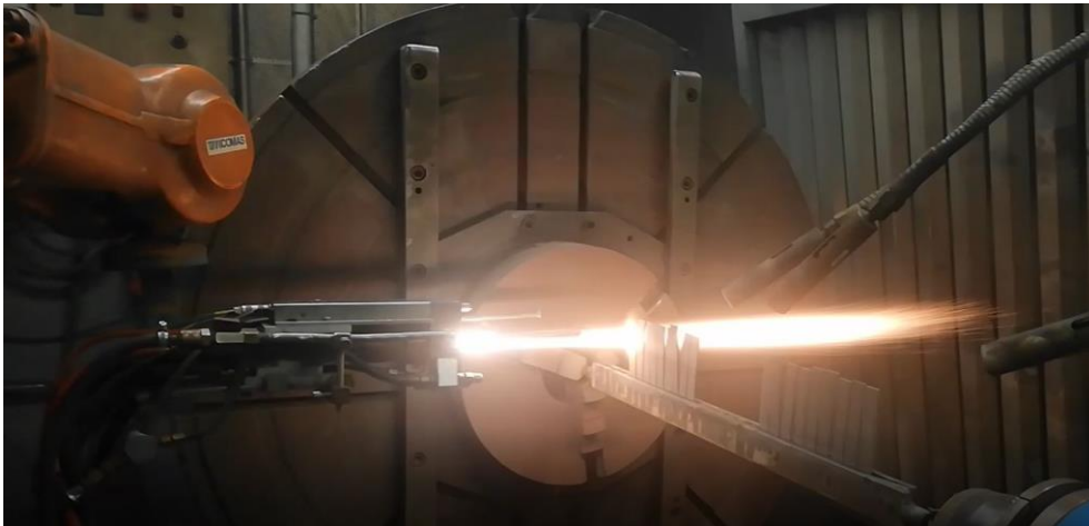
Figura 60. Proyección del recubrimiento Amdry 997(Nº id. 1) mediante HVOF.
