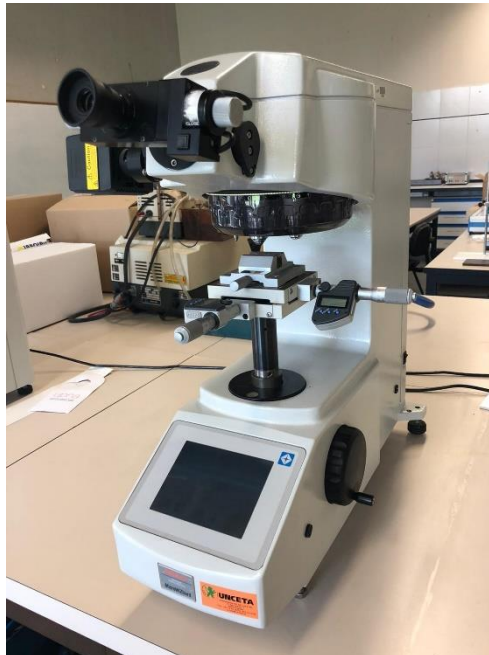
Figura 80. Microdurómetro Mitutoyo modelo HM-211 empleado para evaluar la dureza de los recubrimientos por proyección térmica.
