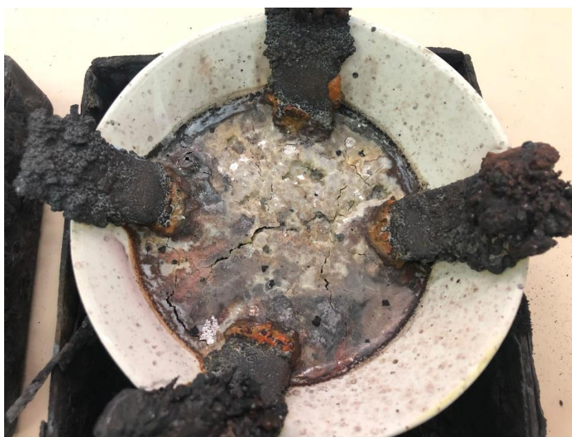
Figura 106. Crisol con las muestras AISI 321 y AISI 347 con el recubrimiento nº2 (Metco 443NS)
