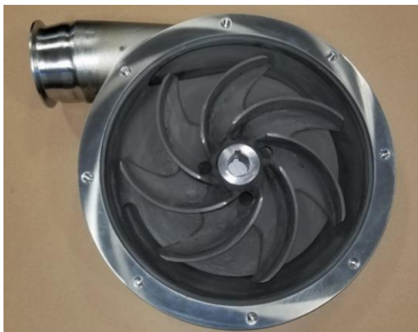
Figura 29. Carcasa y rotor de bomba recubiertos por proyección térmica para dar resistencia al desgaste abrasivo [27].
