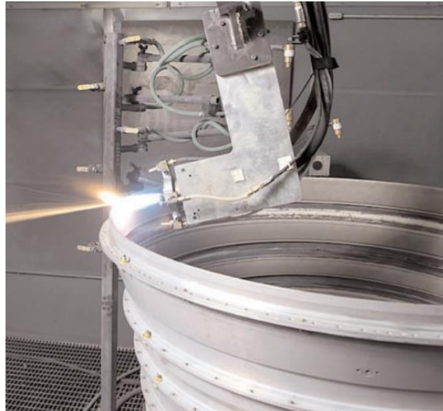
Figura 32. Proyección por plasma de aluminio silicio poliéster en carcasa de compresor de presión intermedia del motor RB211-524 de la compañía Rolls-Royce [29].
