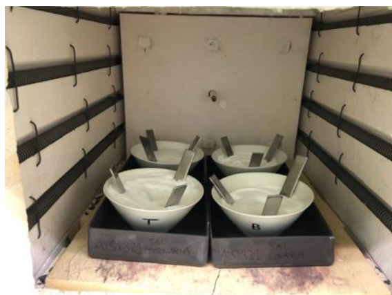
Figura 69. Carga de los crisoles en el horno.
