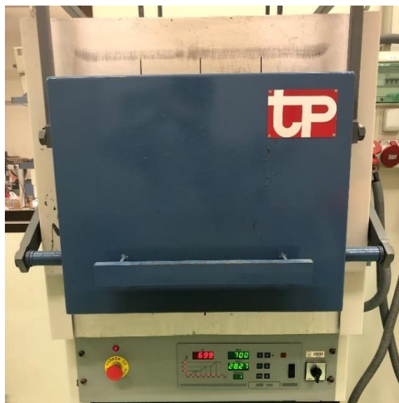
Figura 68. Horno utilizado para el ensayo de corrosión a altas temperaturas en sales fundidas.
