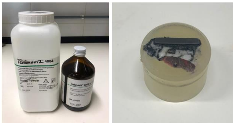
Figura 75. Botes de líquido y polvo Technovit 4004 utilizados para realizar el empastillado en frío junto a una muestra de resultado final.
