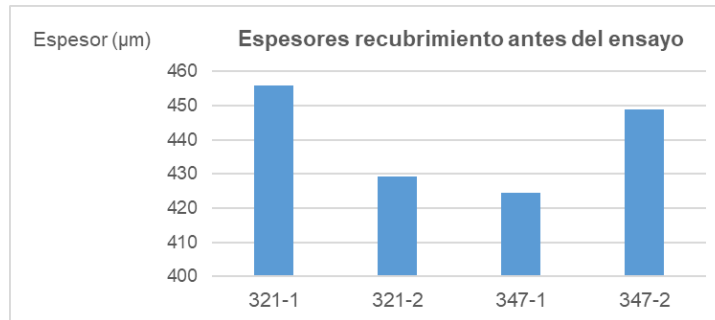
Figura 97. Esposores de los recubrimientos por proyección térmica antes del ensayo de corrosión por sales fundidas.
