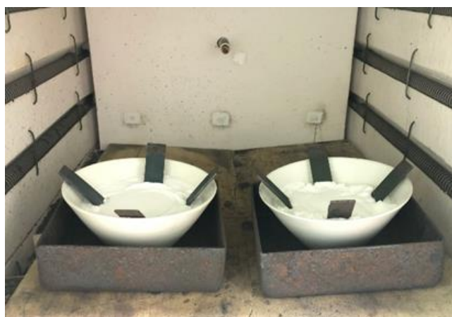
Figura 71. Carga horno grande de crisoles de sal binaria con las muestras 321-1 y 347-1 en el crisol izquierdo; 321-2 y 347-2 en el crisol derecho.
