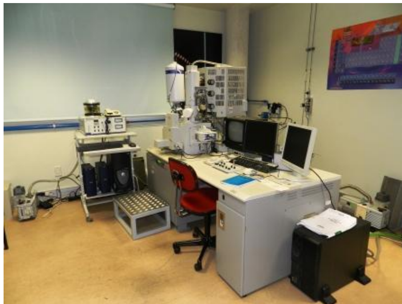
Figura 84. Microscopio electrónico de barrido HITACHI S4800, de tipo cátodo frío [49].
