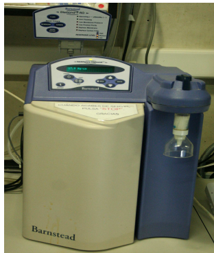
Figura 3.6: Maquina de agua ultrapura
